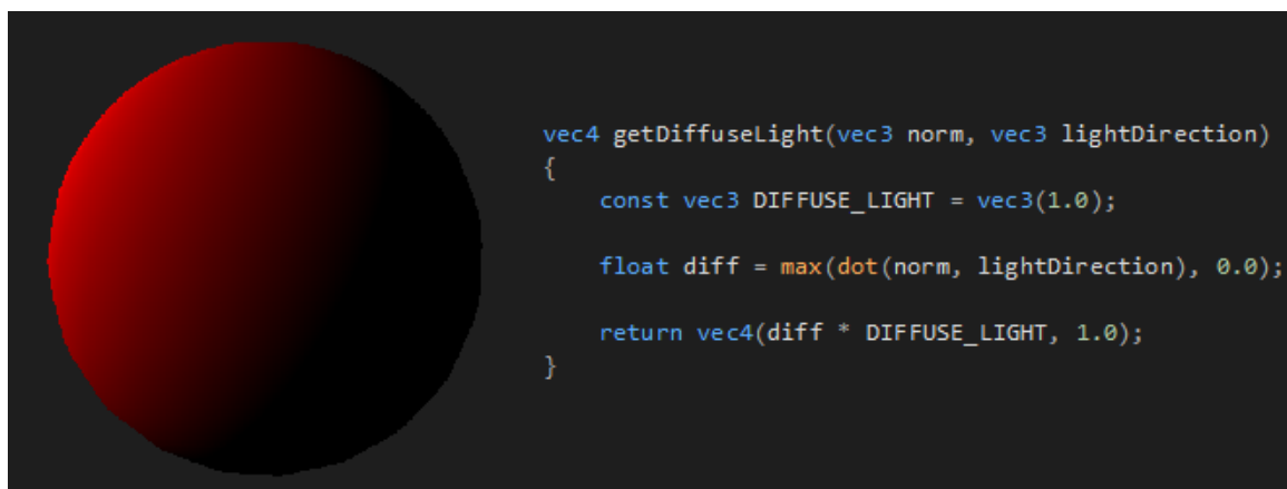
Slika 4.7. Prikaz i implementacija difuzijskog osvjetljenja na modelu sfere
