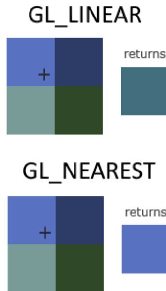
Slika 3.2. Najčešće metode interpolacije piksela teksture u OpenGL-u [6]
