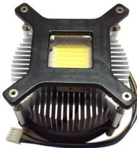
**Slika 2.5.** Primjer LED postavljene na dodatni hladnjak s ventilatorom.
