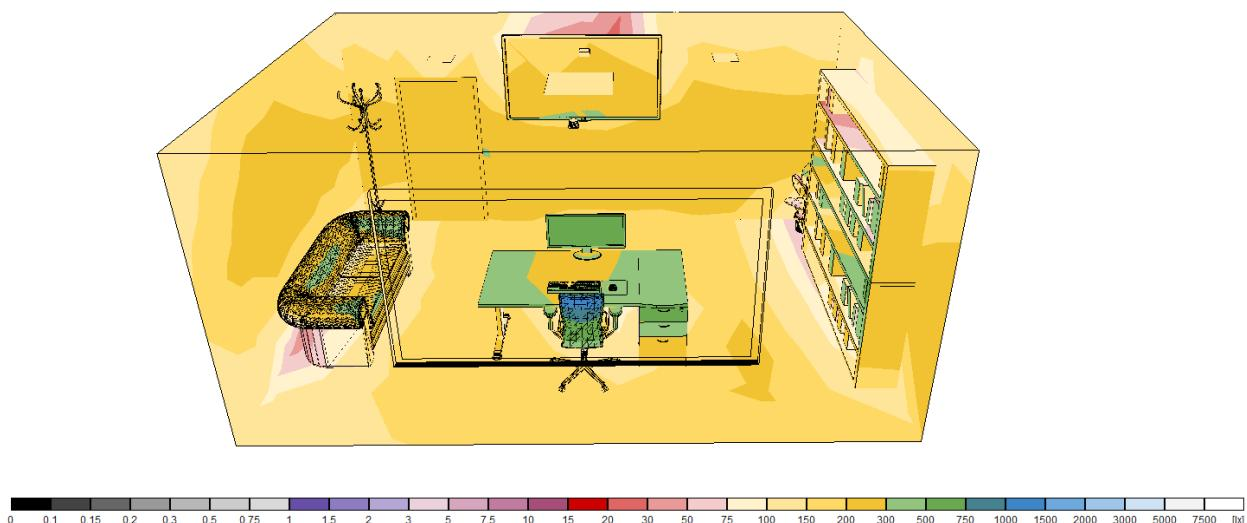
Slika 5.11. 3D prikaz osvijetljenosti dnevnim svjetлом
