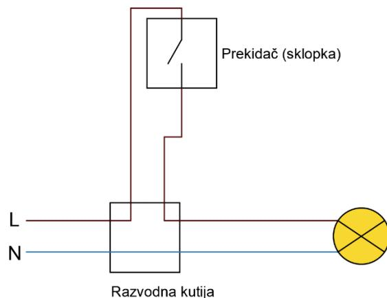
**Slika 3.2.** Klasična instalacija rasvjete, [7].
