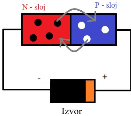
**Slika 2.3.** Pojednostavljeni prikaz P i N – slojeva diode.
