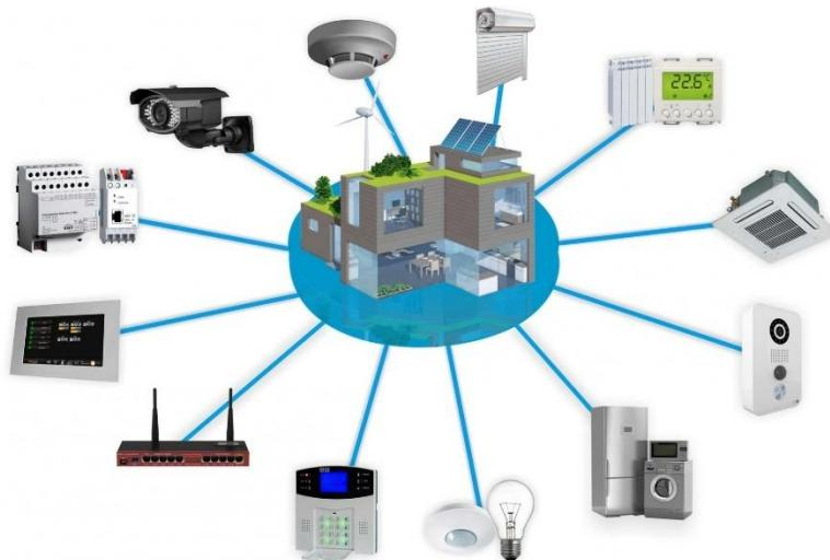
**Slika 3.1.** Prikaz uređaja upravljivih KNX standardom.
