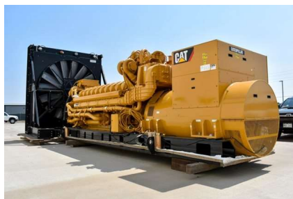
Slika 3.2 Električni generator snage 4000 kw [6]
