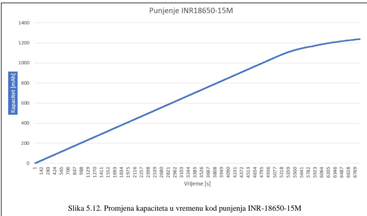
Kapacitet baterije linearno raste pri punjenju baterije Samsung INR18650-15M do trenutka kada napon postaje konstantan, a zatim se povećava u obliku parabole malog nagiba.
