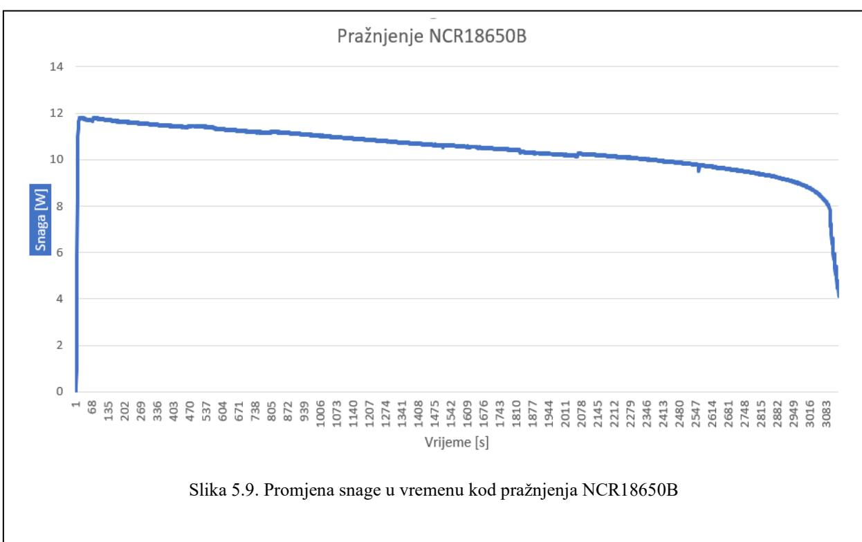
Slika 5.9. Promjena snage u vremenu kod pražnjenja NCR18650B
