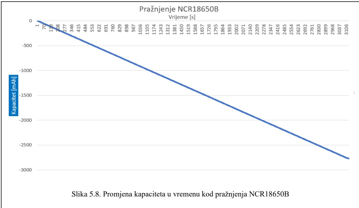
Slika 5.8. Promjena kapaciteta u vremenu kod pražnjenja NCR18650B
