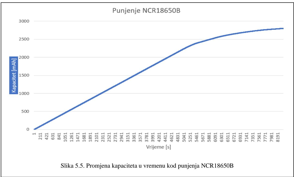
Kapacitet baterije se u vremenu linearno povećavao do trenutka kada napon postaje konstantan, a zatim se povećava u obliku parabole malog nagiba.
