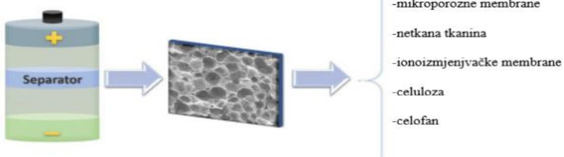
Slika 3.5. Separator litij-ionske baterije
