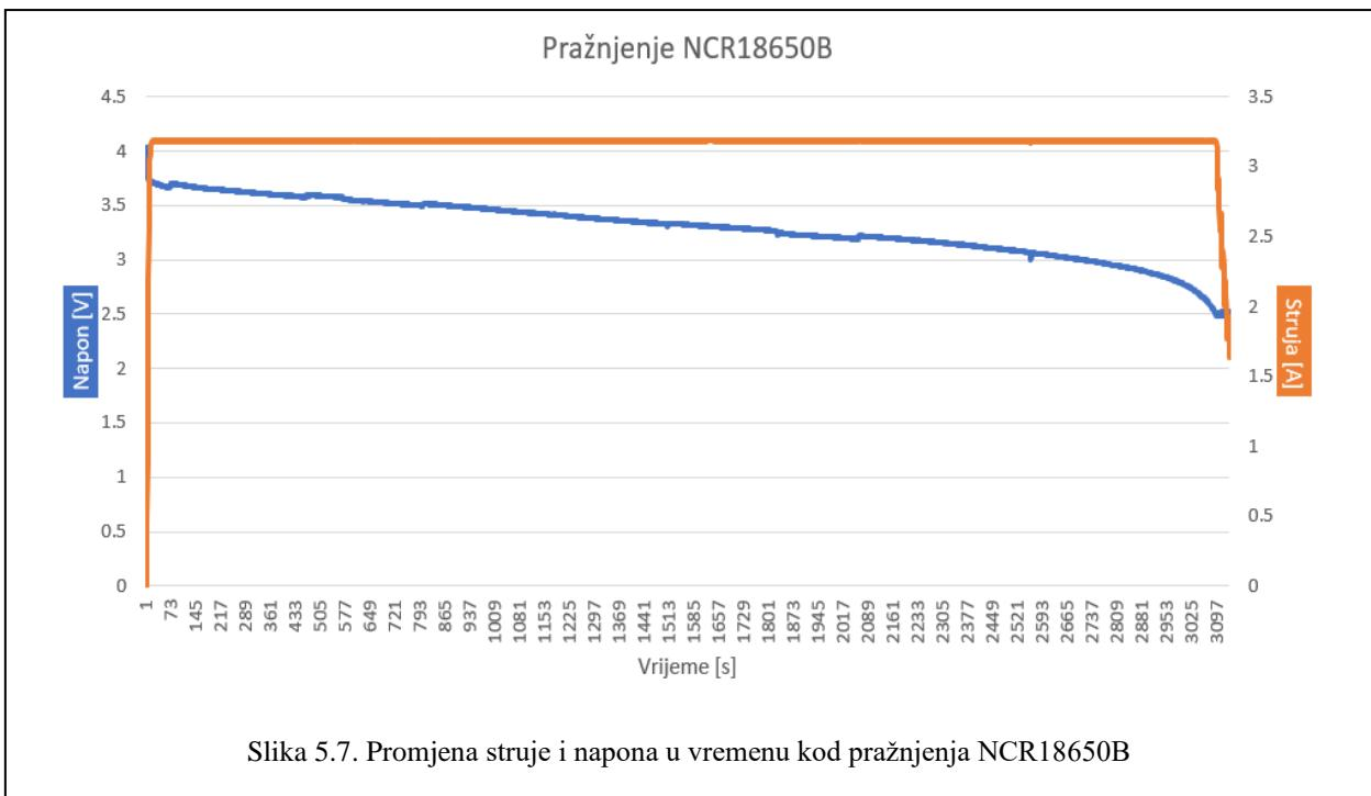
Slika 5.7. Promjena struje i napona u vremenu kod pražnjenja NCR18650B
