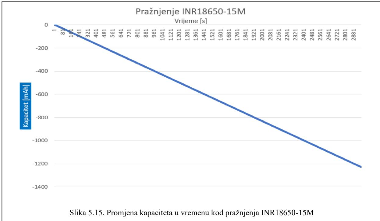
Slika 5.15. Promjena kapaciteta u vremenu kod pražnjenja INR18650-15M
