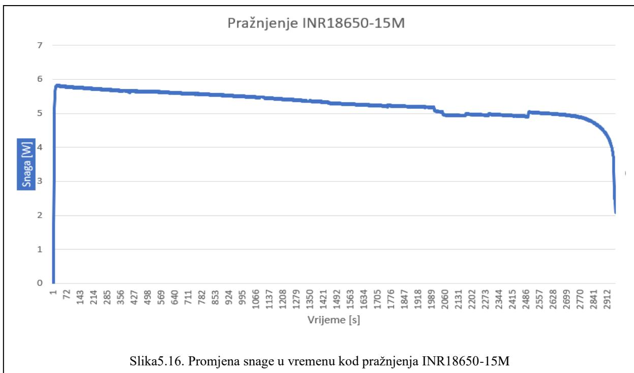
Slika 5.16. Promjena snage u vremenu kod pražnjenja INR18650-15M
