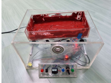
Sl. 4.2. Tresilica zakreće posudicu u lijevo
