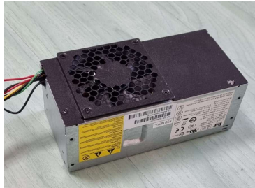
Sl. 3.12. Izvedeno napajanje
