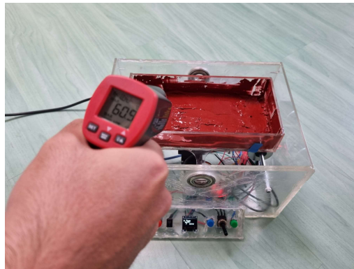
Sl. 4.5. Prikaz temperature na dnu posude
