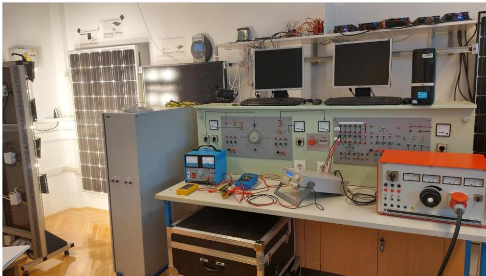
Sl. 5.10. Izvođenje mjerjenja određivanja faktora stabilizacije solarnim panelom.
