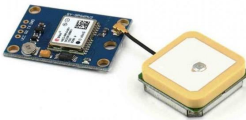
Slika 3.8. NEO-6M GPS modul i antena
