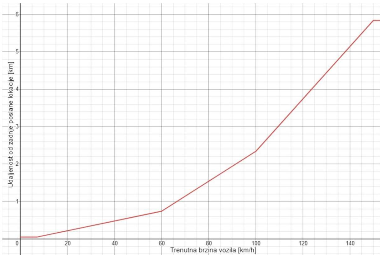
Slika 3.18. Grafički prikaz linije odlučivanja algoritma slanja podataka
