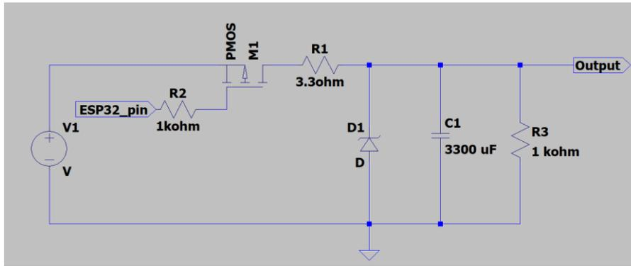
Slika 3.10.. Napajanje SIM800L čipa
