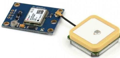
Slika 3.8. NEO-6M GPS modul i antena
