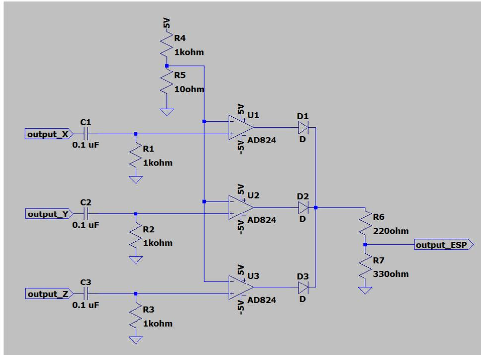
Slika 3.12. Shema detekcije naglih pokreta pomoću analognog akcelerometra
