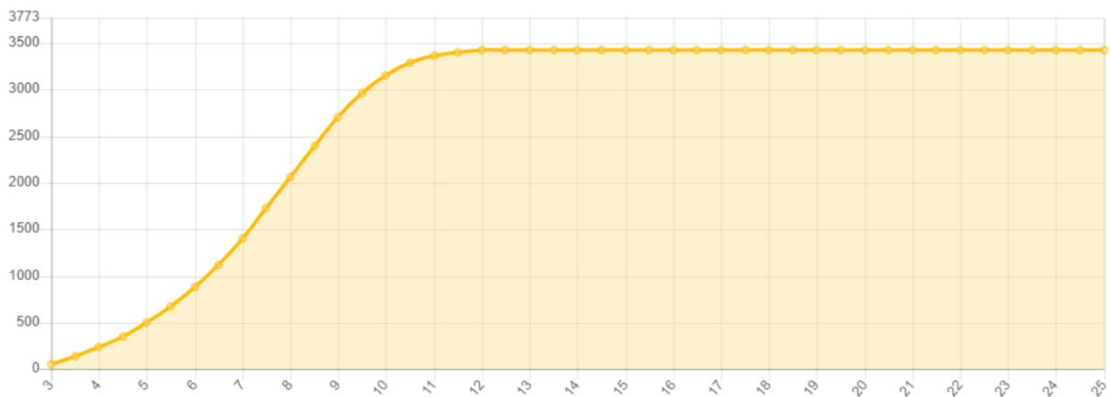
Slika 6.5. Krivulja snage General Electric GE 137 - 3.4 MW vjetroagregata [28]
