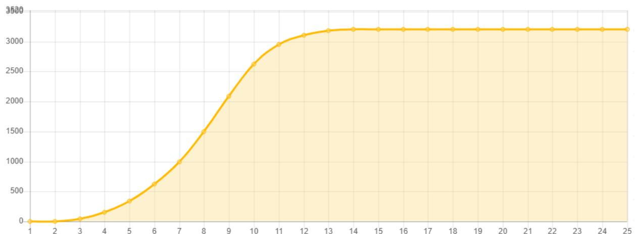
Slika 6.3. Krivulja snage Enercon E – 115 3.2 MW vjetroagregata [28]
