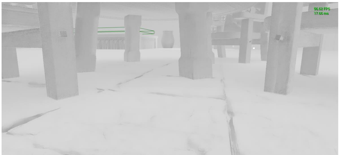
Slika 3.25. RTAO - prikaz doticanja s podom uz 12 uzoraka po pikselu
