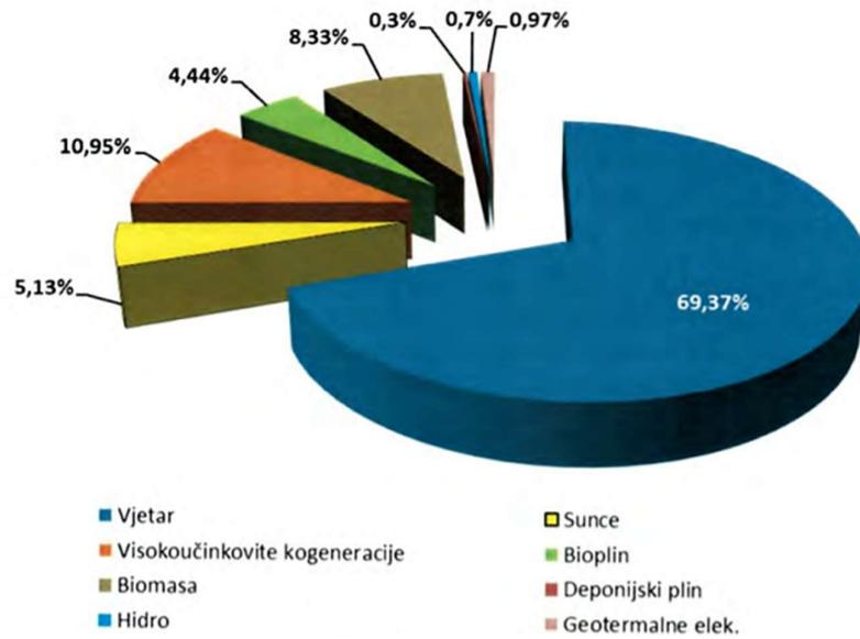
Slika 3.9. Udio pojedinih OIE u ukupnoj instaliranoj snazi. [18]
