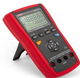
Slika 5.2 RLC metar UT612
