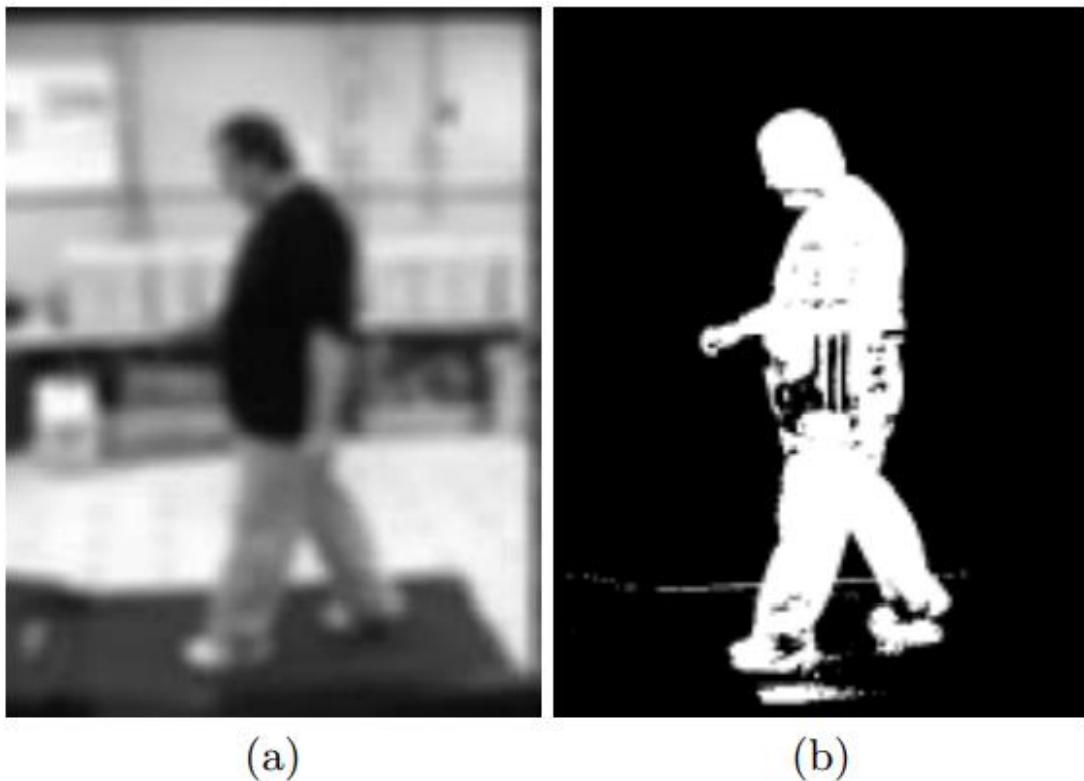
Slika 4.2. Primjer metoda pozadinskog oduzimanja iz MoBo baze podataka [7]: (a) originalna slika, (b) segmentirana slika. [6]
