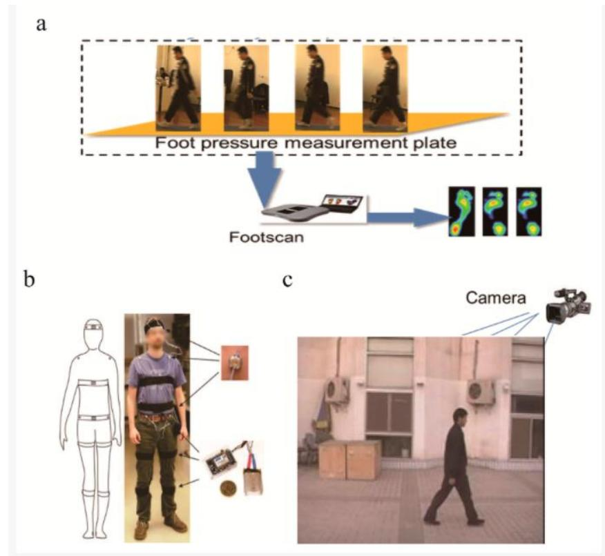
Slika 4.1. Primjeri senzora za sustave prepoznavanja hoda. (a) senzori bazirani na dodir; (b) nosivi senzori: shema (lijevo) slika (desno); (c) video-senzor. [5]
