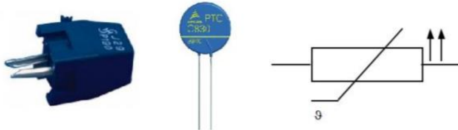
Slika 4.8. Prikaz PTC otpornika i simbol (IEC standard)
