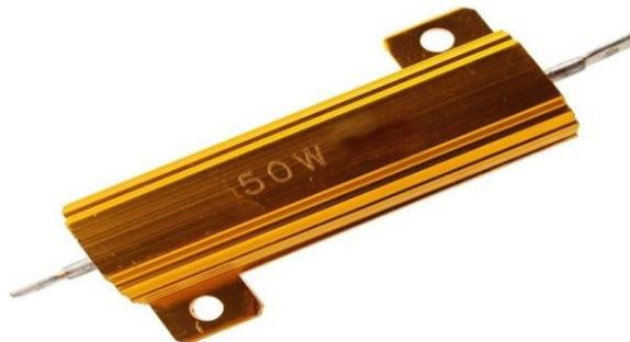
Slika 4.5. Žičani otpornik (snage 50W)
