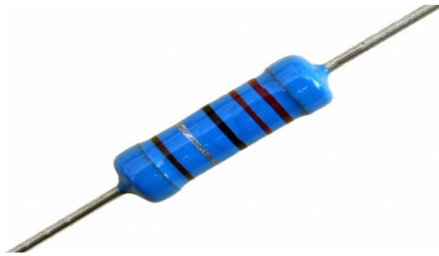
Slika 4.3. Metal-film otpornik (najčešće plave boje)
