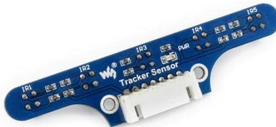
**Slika 2.2** 5-kanalni senzor za praćenje linije (izvor:
