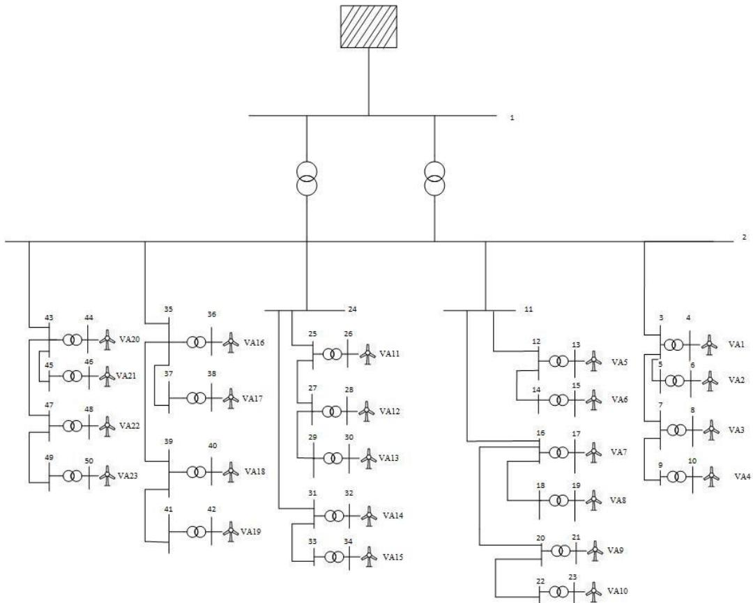
Slika 4.1. Testna shema vjetroparka spojenog na prijenosnu mrežu [16]
