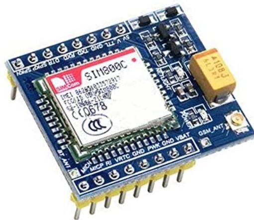
Slika 5. GSM/Bt modul (SIM800C)
