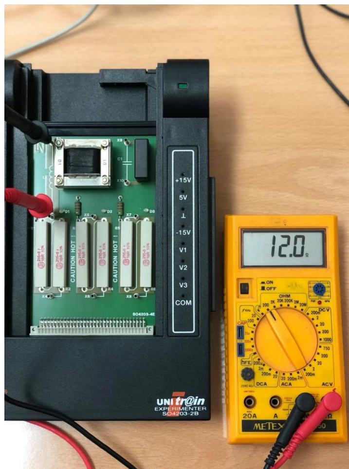
Slika 4.15. Proces određivanja otpornosti prigušnice R
