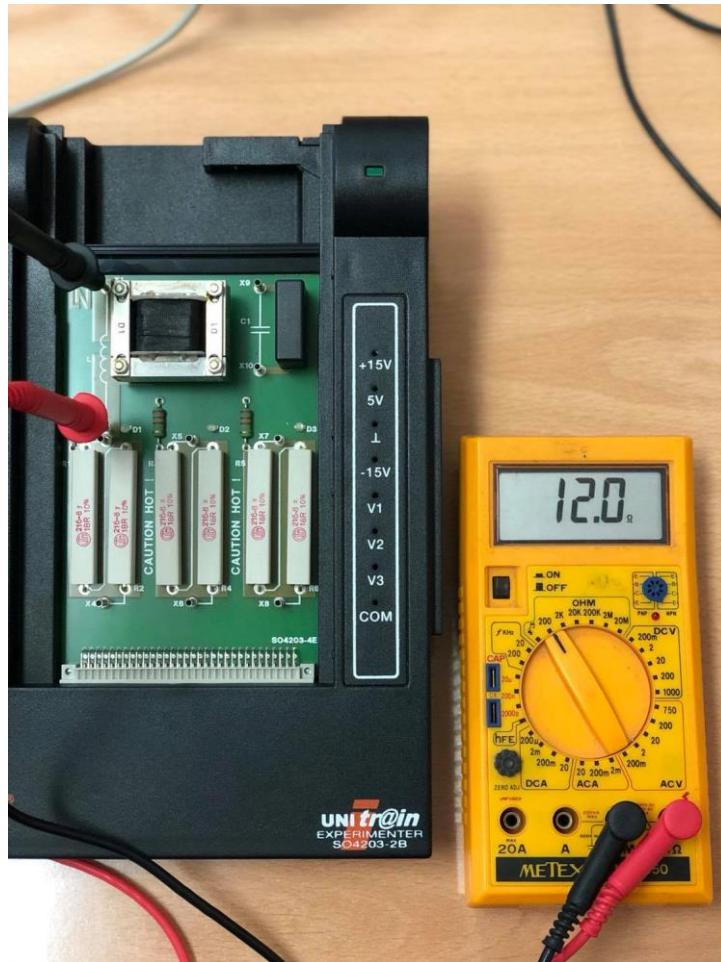
**Slika 4.15.** Proces određivanja otpornosti prigušnice  $R$
