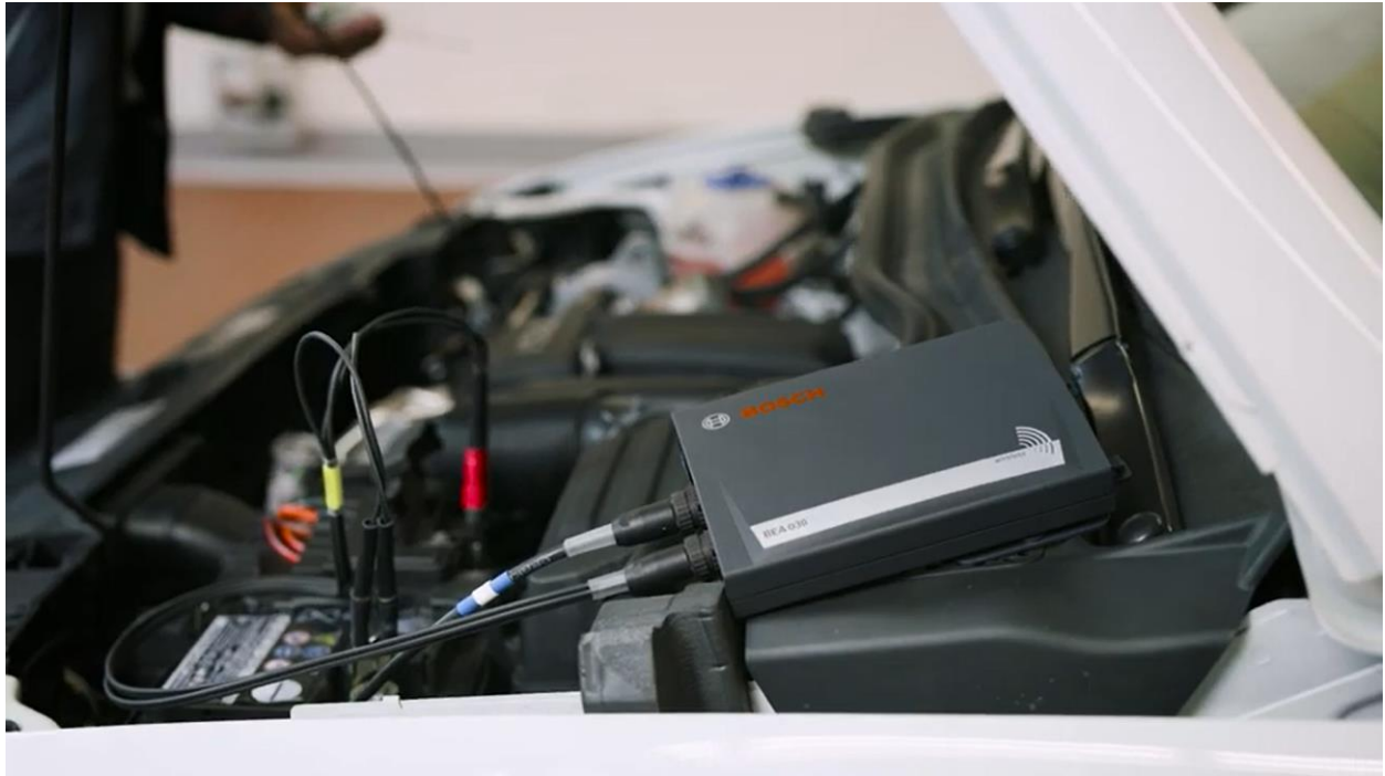
Sl. 2.6. Mjerenje broja okretaja motora preko kontakata akumulatora.
