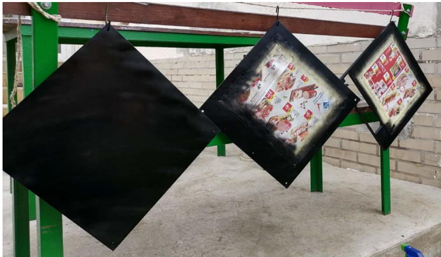
Slika 4.3. Dijelovi tijela sata nakon bojanja crnom akrilnom bojom.
