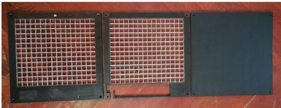
Slika 4.4. Dijelovi tijela sata nakon završenog procesa bojanja.
