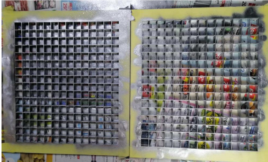
Slika 4.2. Dijelovi tijela sata nakon bojanja reflektivnih površina srebrnom reflektivnom bojom.
