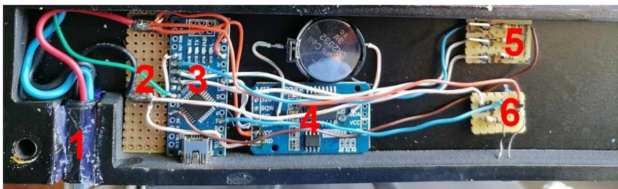
**Slika 4.6.** Označeno brojem (1): Dvopolni utikač za napajanje; (2): pozitivni i negativni terminali; (3): Arduino Nano razvojna pločica; (4): DS3231 RTC modul; (5): sklop senzora kapacitivnih tipki; (6): sklop senzora za očitavanje jačine osvjetljenja okoline.
