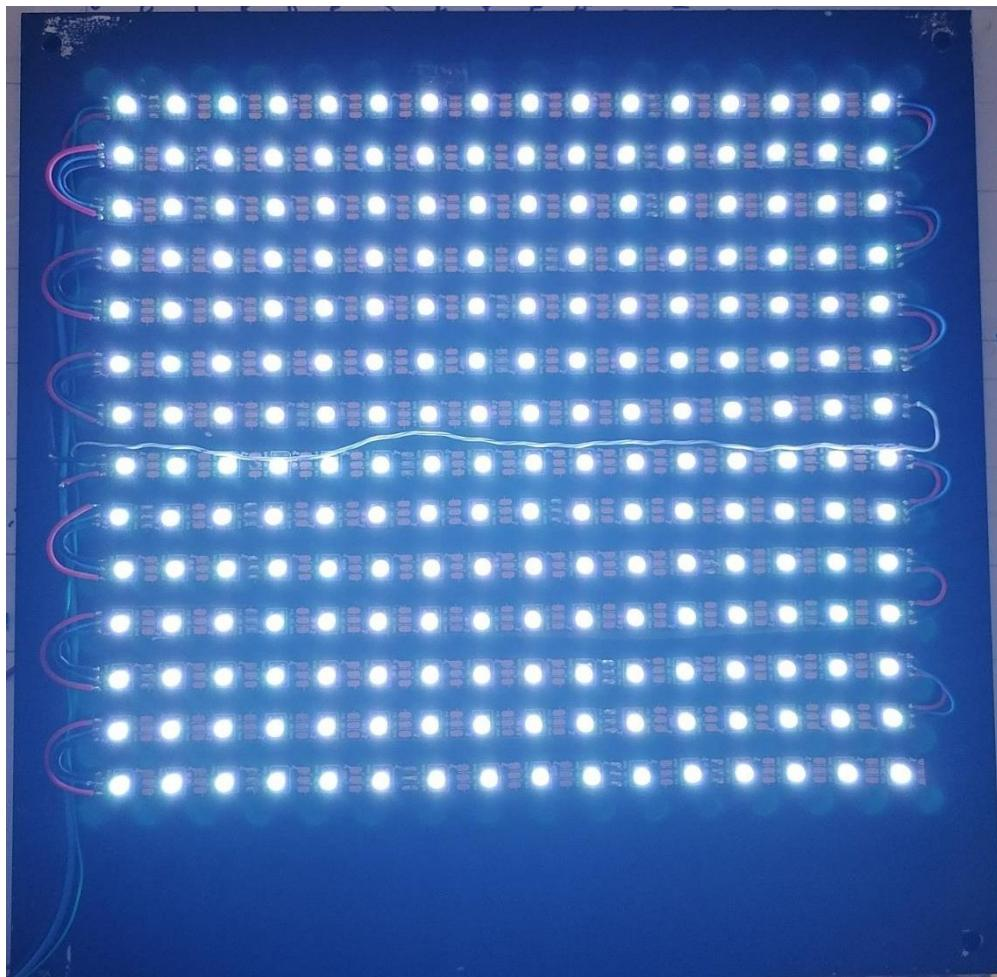
Slika 4.5. Testiranje rada matrice LE dioda.
