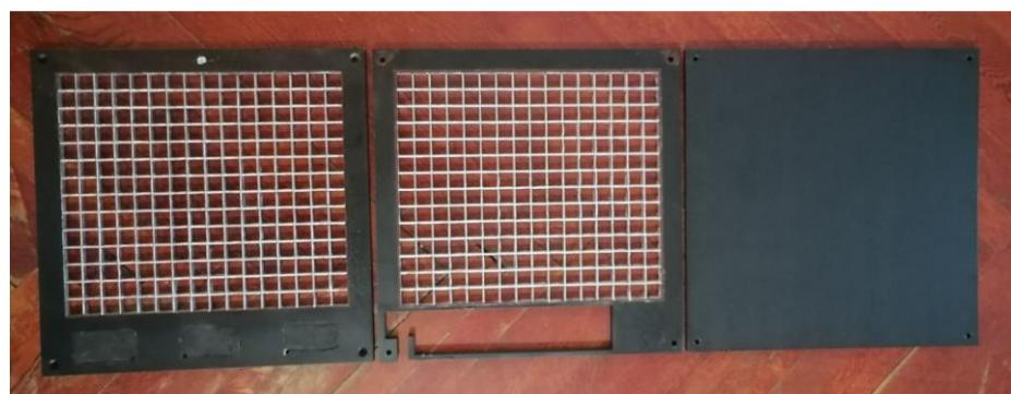
**Slika 4.4.** Dijelovi tijela sata nakon završenog procesa bojanja.
