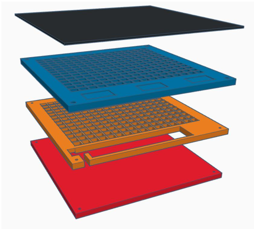
**Slika 3.4.** Slojeviti dizajn kućišta prikazan u 3d prostoru.
