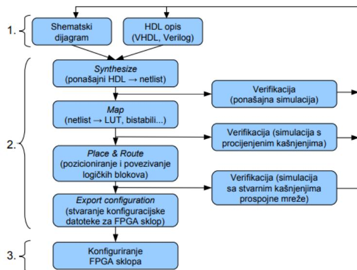
Slika 2.3. Koraci pri procesu sinteze konfiguracije FPGA.
