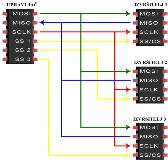
Slika 4.9. Paralelno spajanje upravljača sa više izvršitelja.
