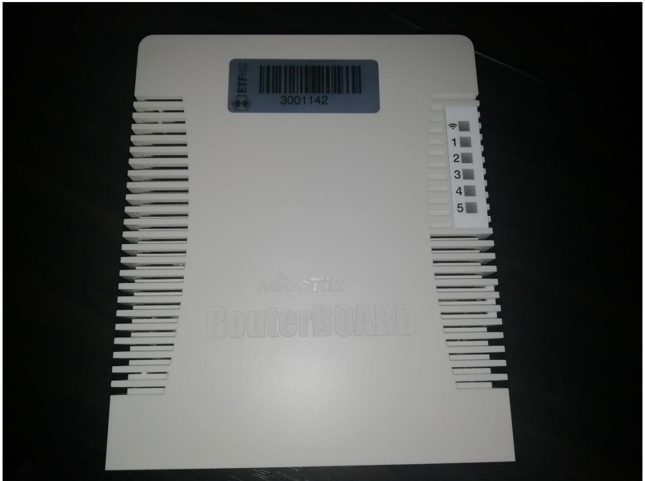
Slika 4.4. Prikaz gornje strane uređaja sa LED oznakama
