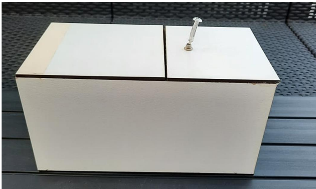
Slika 3.12. KORAK 1: sklopka je isključena, te je beskorisna kutija u stanju pripravnosti.
