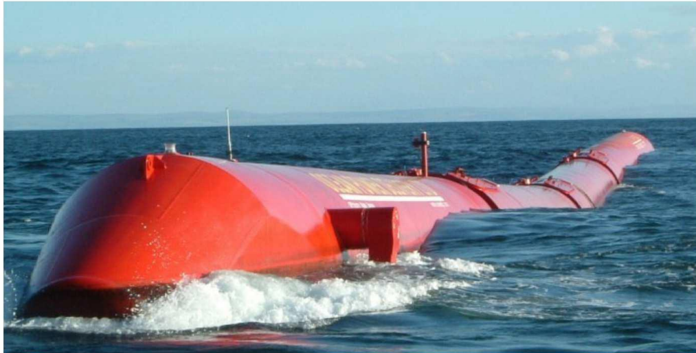
Slika 3.2. Pelamis – primjer prigušnika [1]
