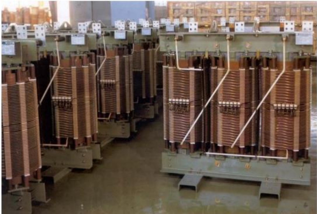
Slika 3.11. Suhi distributivni transformator [12].
