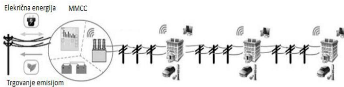
Slika 2-3 Primjer mikromreže na razini NN napojnog voda [4]
