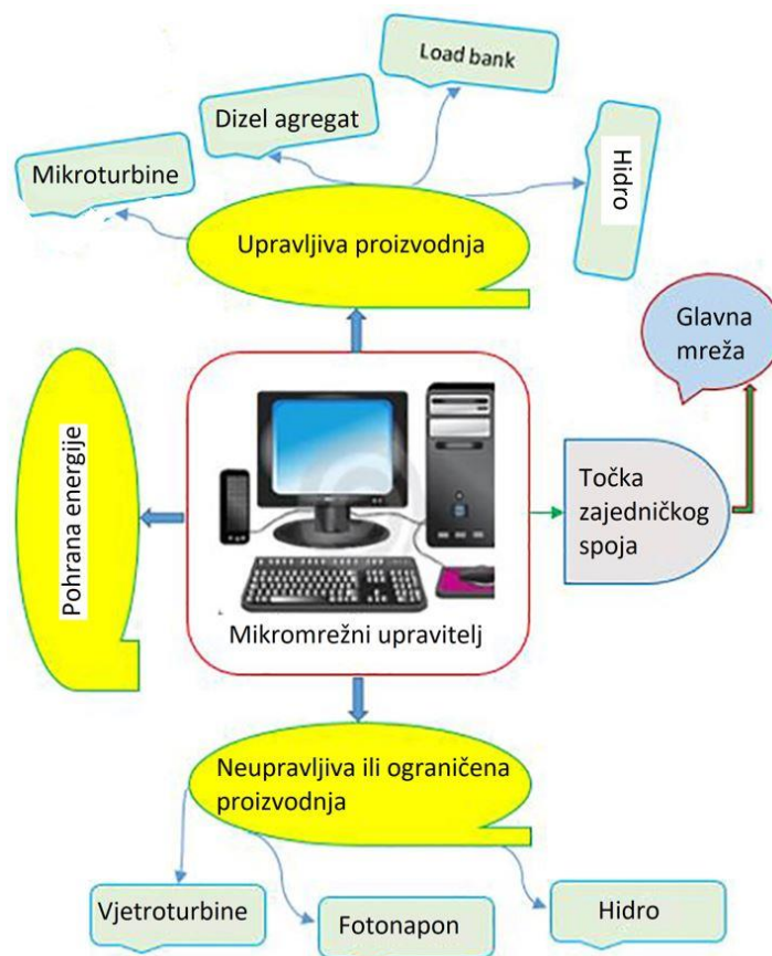
Slika 2-9 Shema mikromreže s različitim izvorima energije [6]
