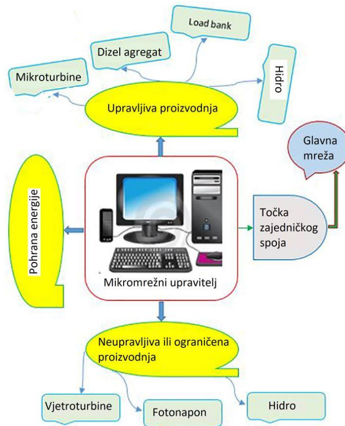
Slika 2-9 Shema mikromreže s različitim izvorima energije [6]
