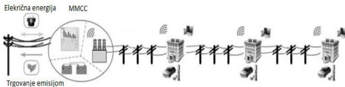
Slika 2-3 Primjer mikromreže na razini NN napojnog voda [4]
