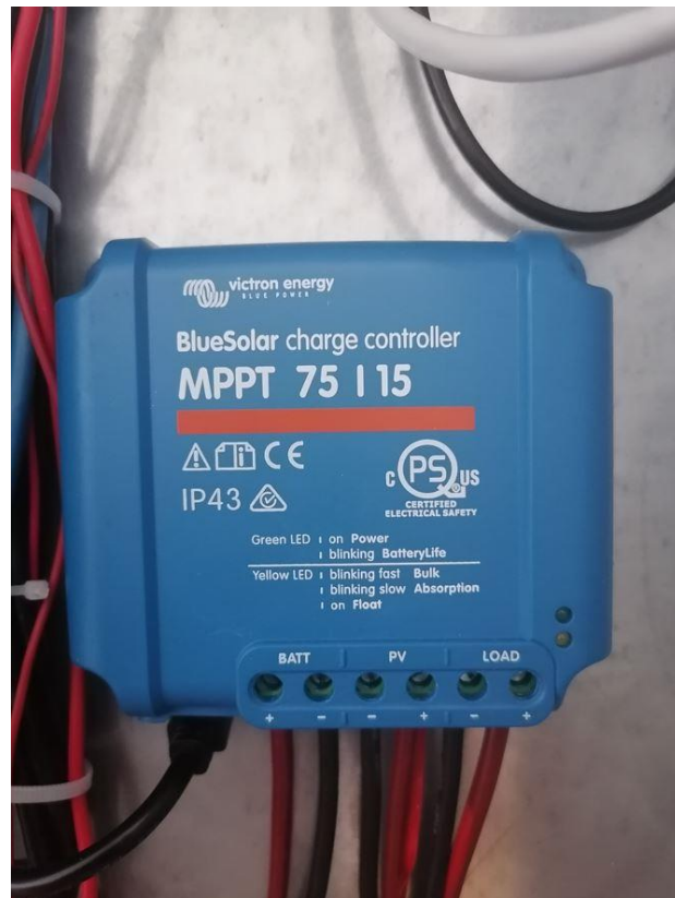
Slika 4-3 BlueSolar regulator punjenja MPPT 75 | 15
