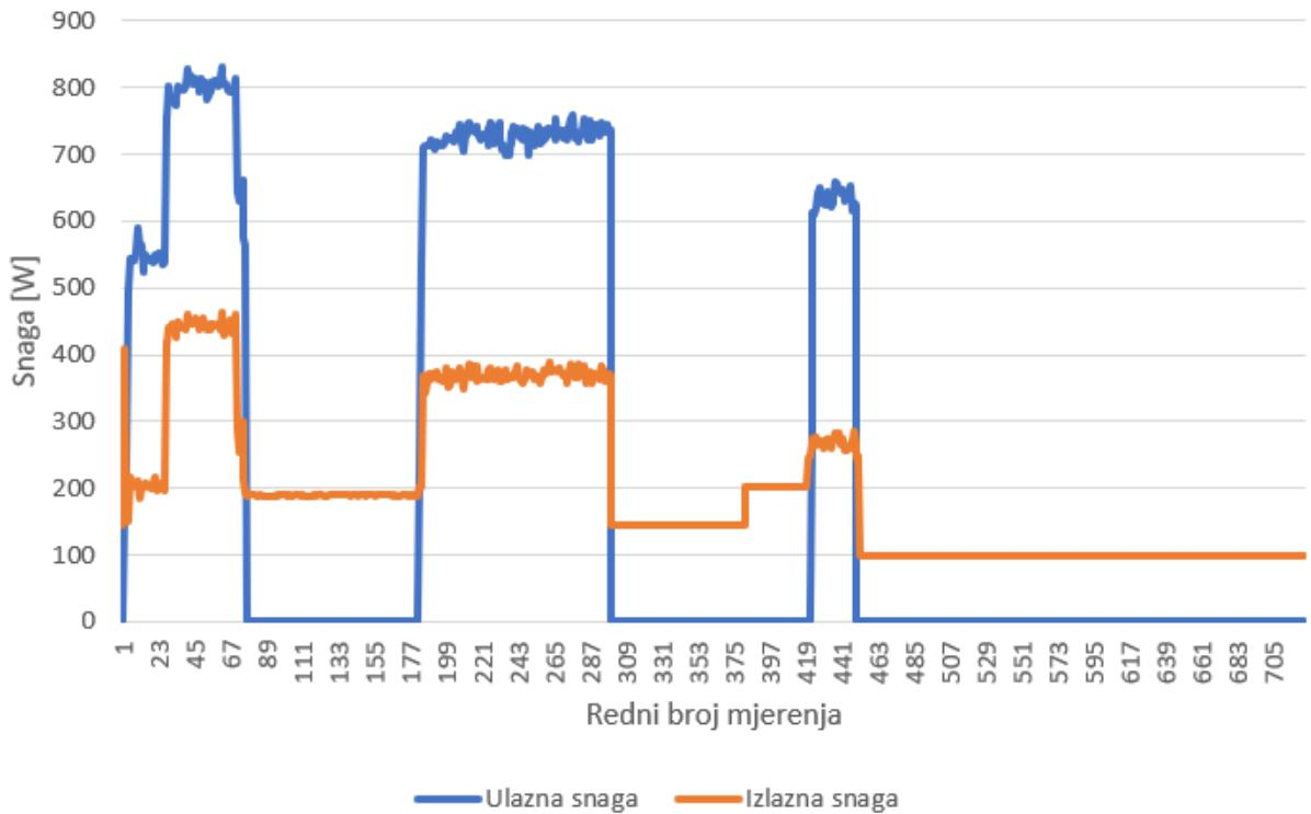
Slika 4-27 Ulazna i izlazna snaga izmjenjivača
