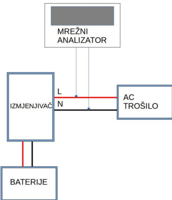
Slika 4-35 Shema mjernog postava
