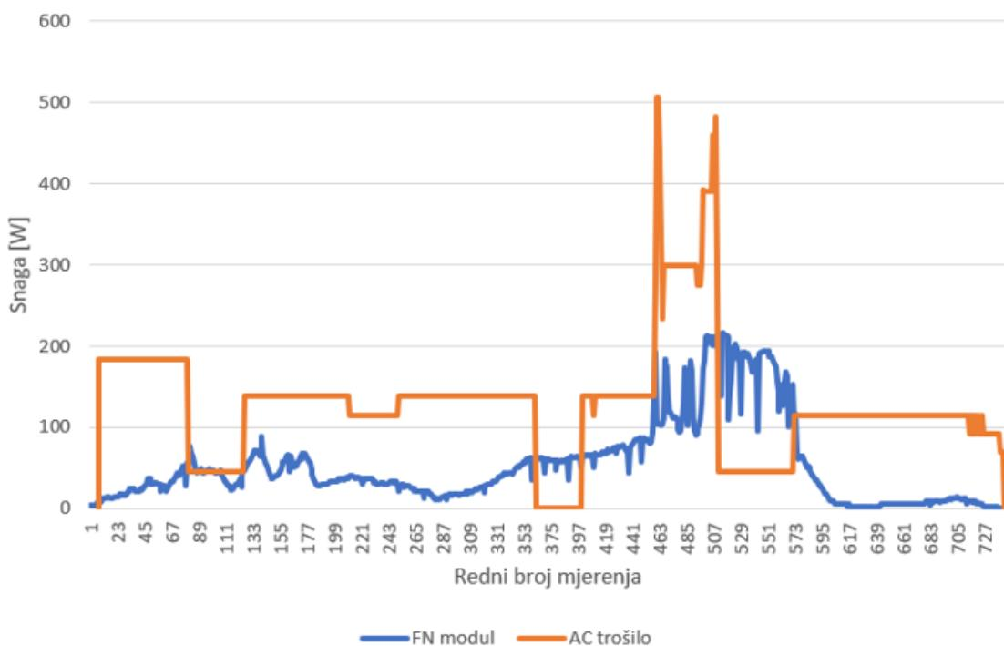
Slika 4-24 Snage AC opterećenja i FN modula
