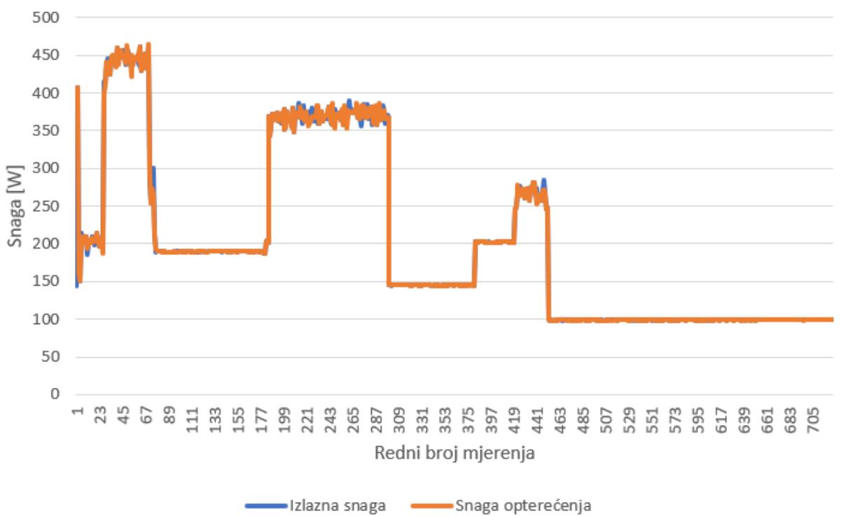
Slika 4-28 Izlazna snaga izmjenjivača i snaga AC trošila
