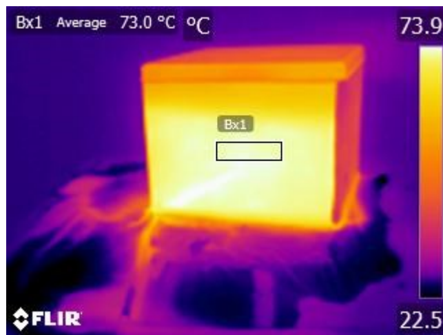
Slika 4.33. Termogram metalne kutije pri kutu 10° (-80°)
