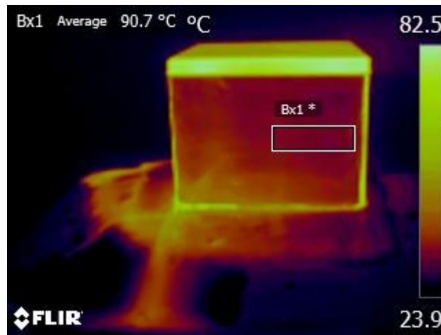
Slika 4.8. Termogram metalne površine pri \varepsilon = 0,14
