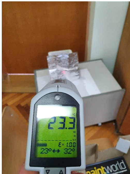
Slika 4.6. Mjerenje reflektiranog zračenja uz pomoć pirometra
