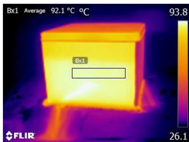
*Slika 4.10. Termogram metalne kutije pri kutu  $10^\circ$  ( $-80^\circ$ )*
