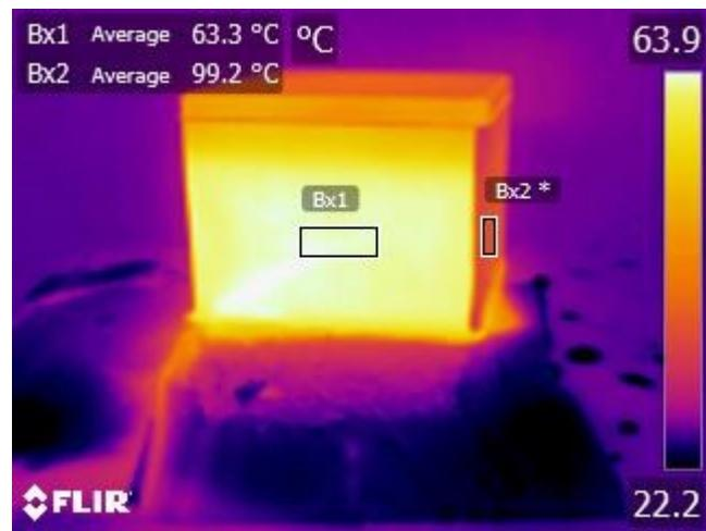
**Slika 4.44.** Termogram metalne kutije pri kutu  $10^\circ$  ( $-80^\circ$ )
