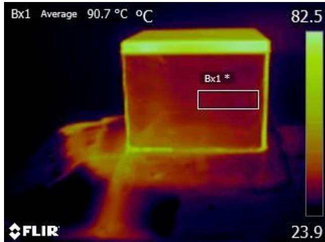
*Slika 4.8. Termogram metalne površine pri  $\varepsilon = 0,14$*
