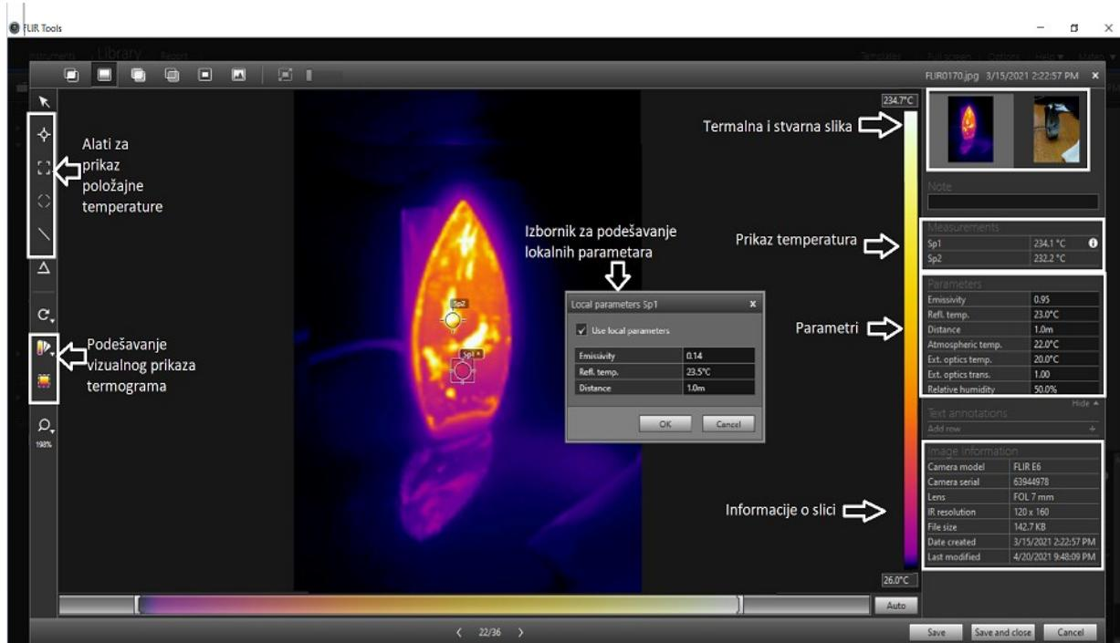
*Slika 3.5 Prikaz termograma u FLIR tools programskom paketu*
