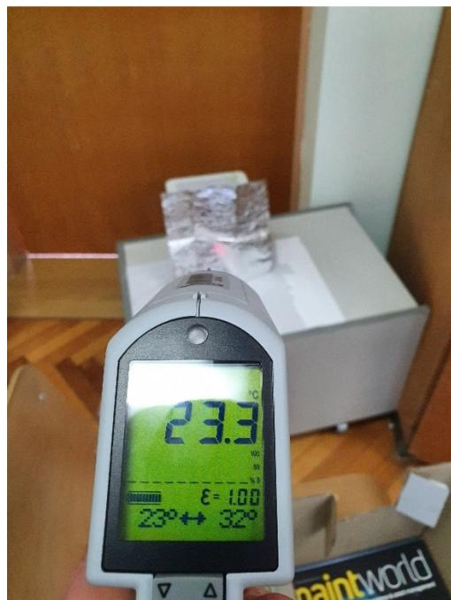
*Slika 4.6. Mjerenje reflektiranog zračenja uz pomoć pirometra*
