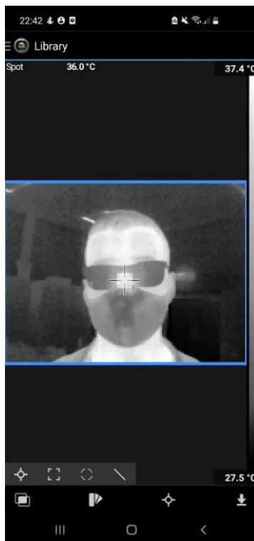
*Slika 3.4 Termogram u mobilnoj aplikaciji FLIR tools*
