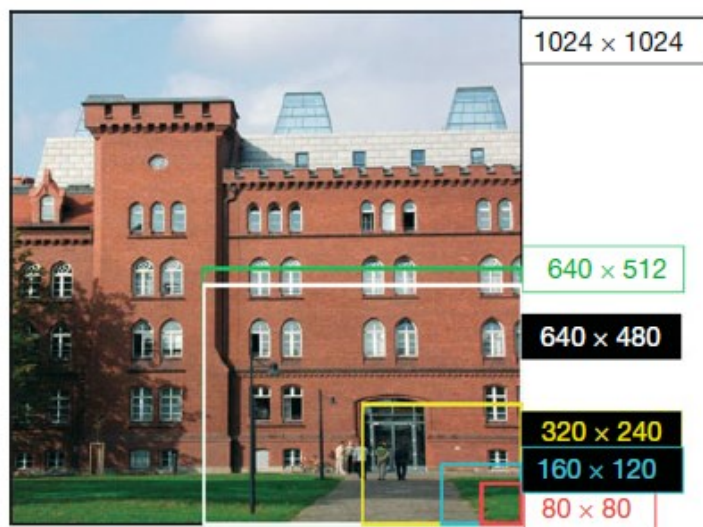
Slika 3.2. Prikaz različite razlučivosti IC termalnih kamera [1]
