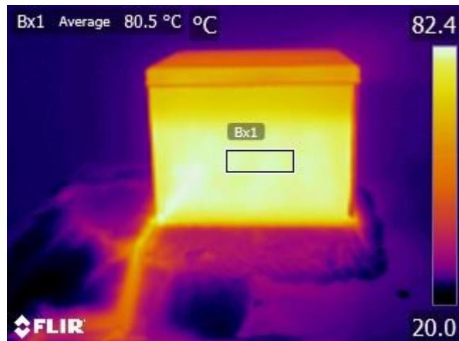
Slika 4.21. Termogram metalne kutije pri kutu  $0^{\circ}$  ( $-90^{\circ}$ )
