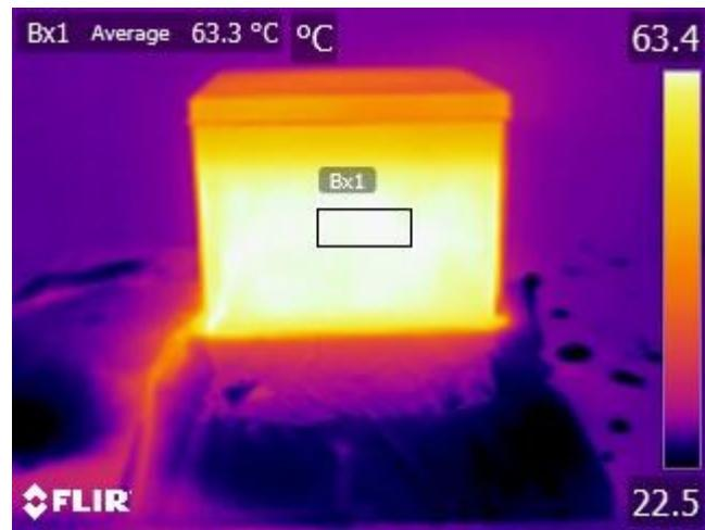
**Slika 4.43.** Termogram metalne kutije pri kutu  $0^\circ$  ( $-90^\circ$ )
