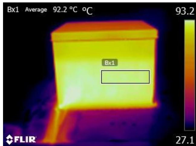
*Slika 4.9. Termogram metalne kutije pri kutu  $0^\circ$  ( $-90^\circ$ )*
