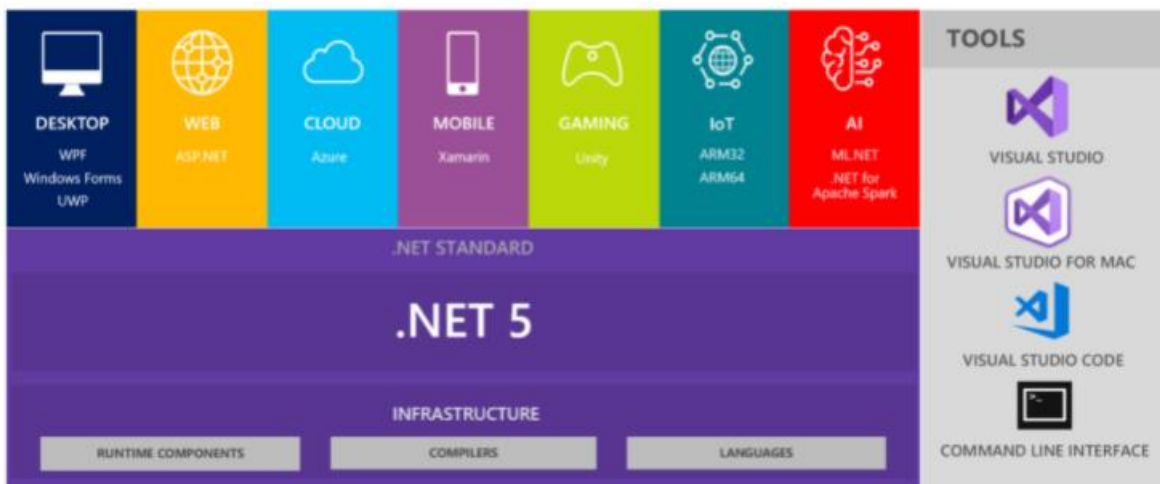
Slika 3.2. Prikaz strukture .NET 5 platforme 3
