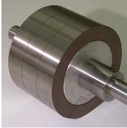
Slika 6.7. Rotor histereznog sinkronog motora [38].
