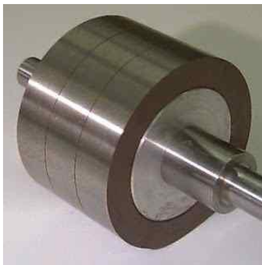
Slika 6.7. Rotor histereznog sinkronog motora [38].
