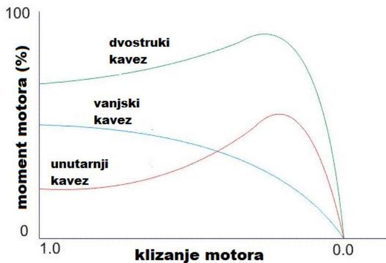
**Slika 7.8.** Momentne karakteristike trofaznih asinkronih motora [55].
