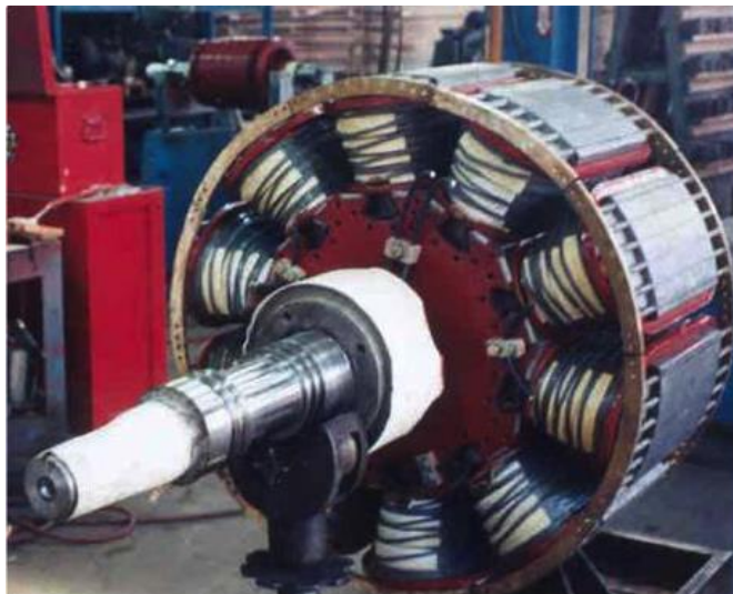
Slika 6.6. Sinkroni motor s kavezom asinkronog motor za zalet [37].
