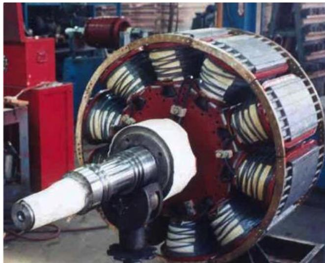
Slika 6.6. Sinkroni motor s kavezom asinkronog motora za zalet [37].
