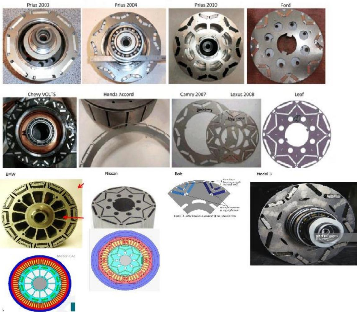
**Slika 6.14.** Prikaz dizajna rotora elektromotora raznih proizvođača električnih automobila [46].
