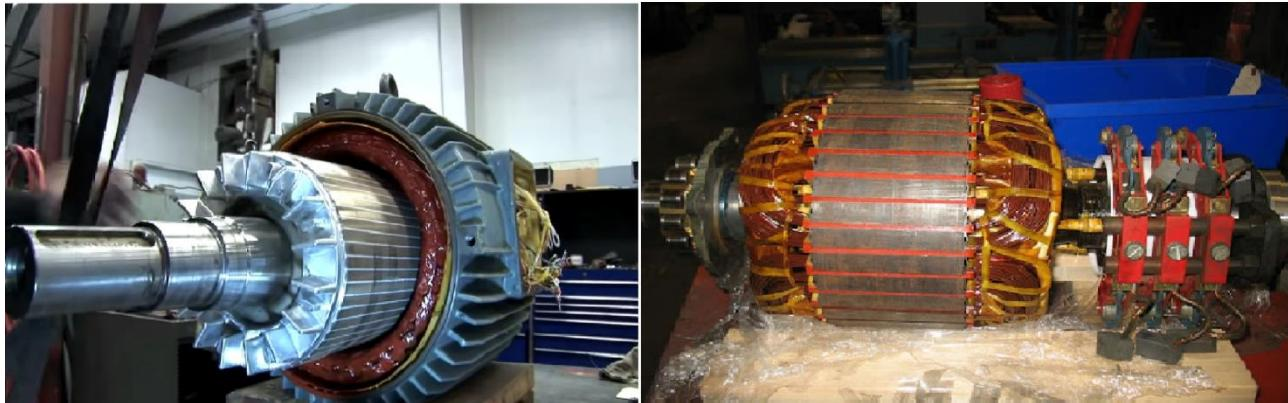
**Slika 7.6.** Trofazni asinkroni motor s kaveznim rotorom lijevo i s kliznim prstenovima desno [51, 52].
