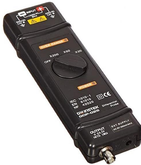
Slika 3.5. Diferencijalna naponska sonda GW-Instek GDP-025[21]
