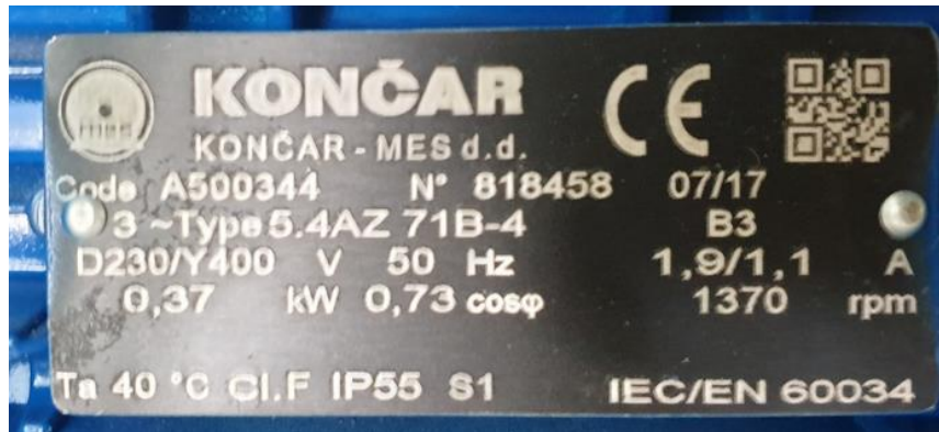
Slika 2.4. Natpisna pločica ispitivanog asinkronog motora
