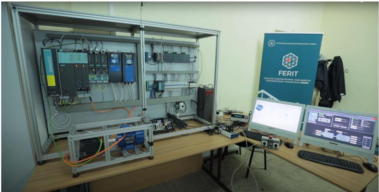
Slika 3.8. Stanica za automatizirano ispitivanje asinkronih motora
