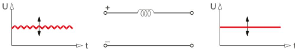
Sl. 2.9. Strujni međukrug s valnim oblicima napona i struje[3]
