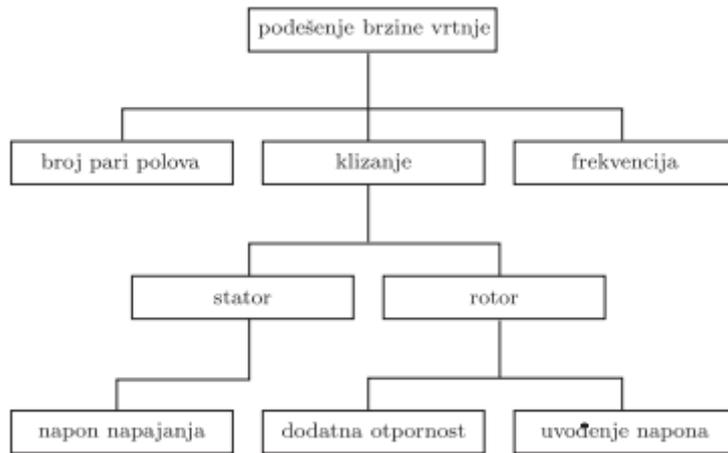
Sl. 3.1. Načini podešenja brzine vrtnje asinkronog motora[5]
