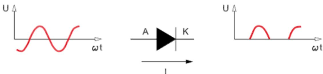
Slika 2.5. Dioda s valnim oblicima napona i struje[3]
