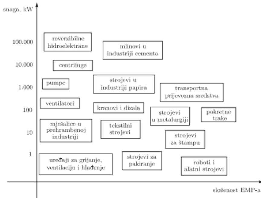
Sl. 4.2. Snage i složenost elektromotornog pogona[5]
