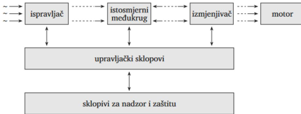
Sl. 2.4. Blokowska shema pretvarača s istosmjernim međukrugom[1]
