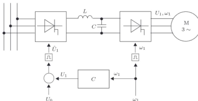
Sl. 2.13. Osnovna shema skalarnog upravljanja asinkronim motorima[5]
