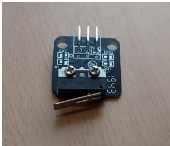
Slika 7. tipka , endstop za 3D pisač
