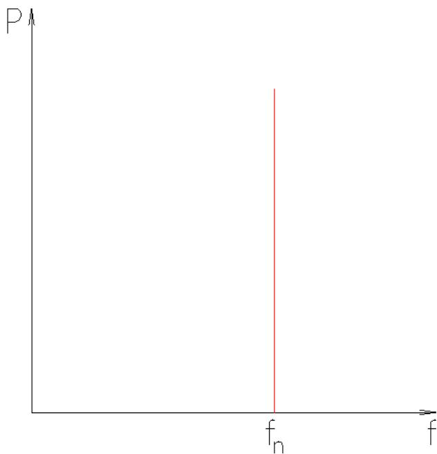
**Slika 3.3.** Staticka karakteristika astatickog regulatora.
