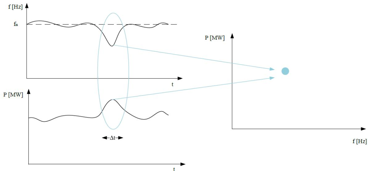
**Slika 5.3.** Grafički prikaz vremenski sinkroniziranih mjerena snage i frekvencije [18].
