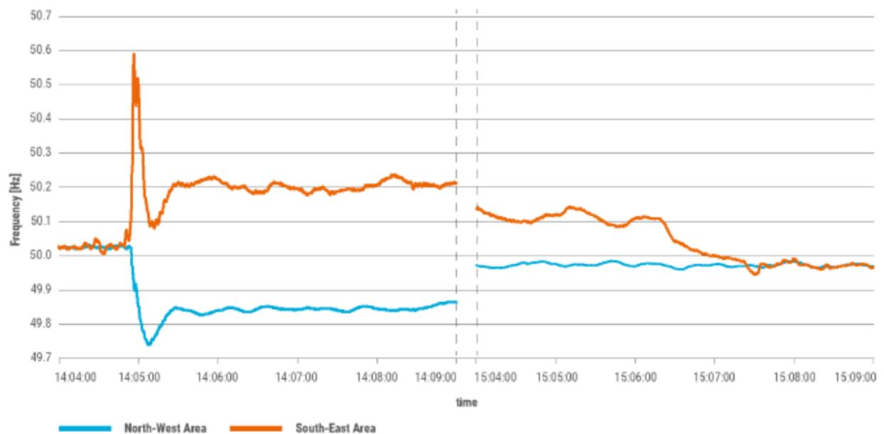
**Slika 6.2.** Ovisnost frekvencije o vremenu uslijed poremećaja I [22].
