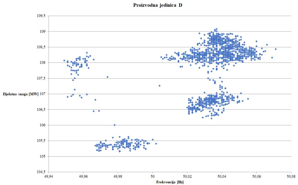
**Slika 6.19.** Grafički prikaz ovisnosti izlazne djelatne snage proizvodne jedinice D o frekvenciji.
