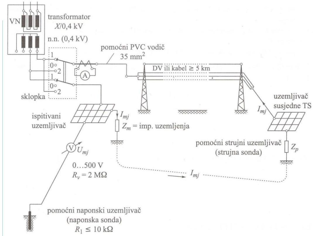
Slika 5.1. Shema mjerenja U-I metodom na mrežastom uzemljivaču [1]
