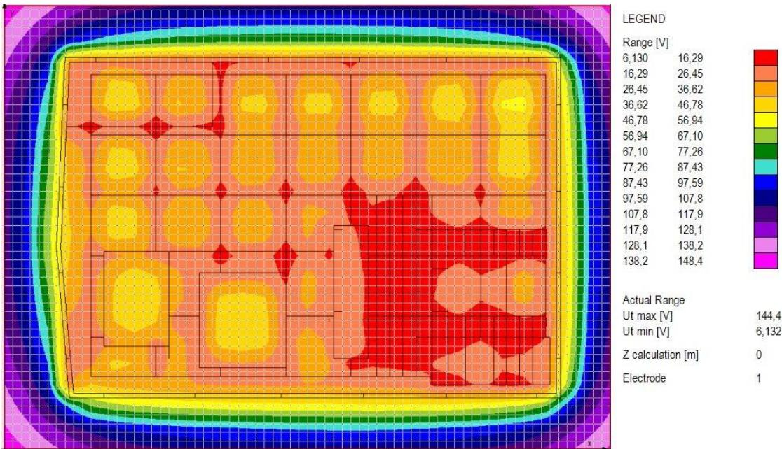
Slika 6.22. 2D prikaz napona dodira, ograda galvanski spojena
