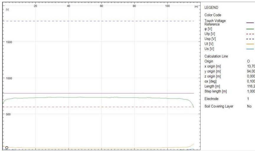
Slika 6.50. Graf napona dodira i koraka uz istočnu ogradu na udaljenosti 1m, ograda galvanski spojena
