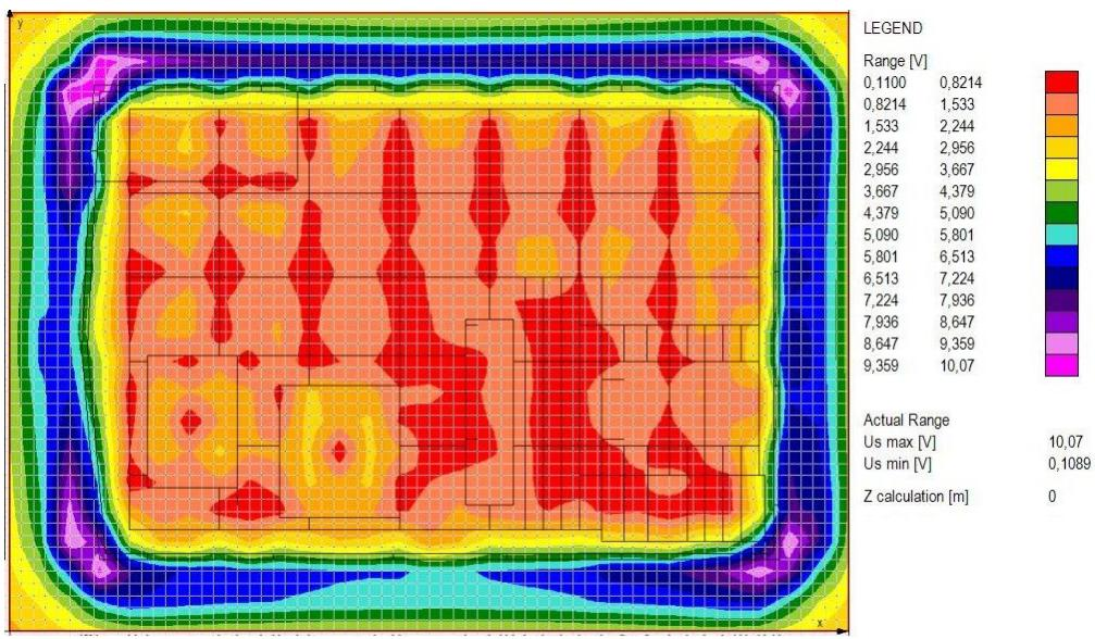
Slika 6.47. 2D prikaz napona koraka, ograda galvanski spojena
