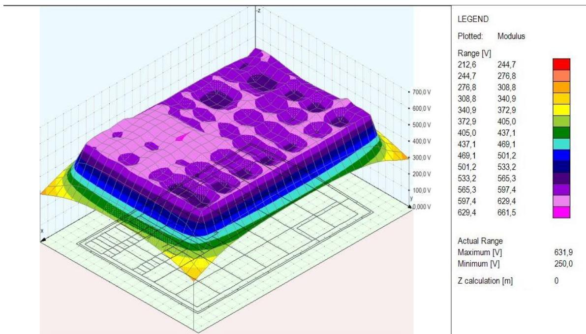
Slika 6.21. 3D prikaz raspodjele potencijala zemljišta, ograda galvanski spojena
