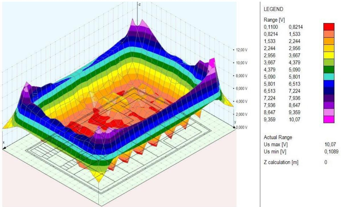
Slika 6.48. 3D prikaz napona koraka, ograda galvanski spojena
