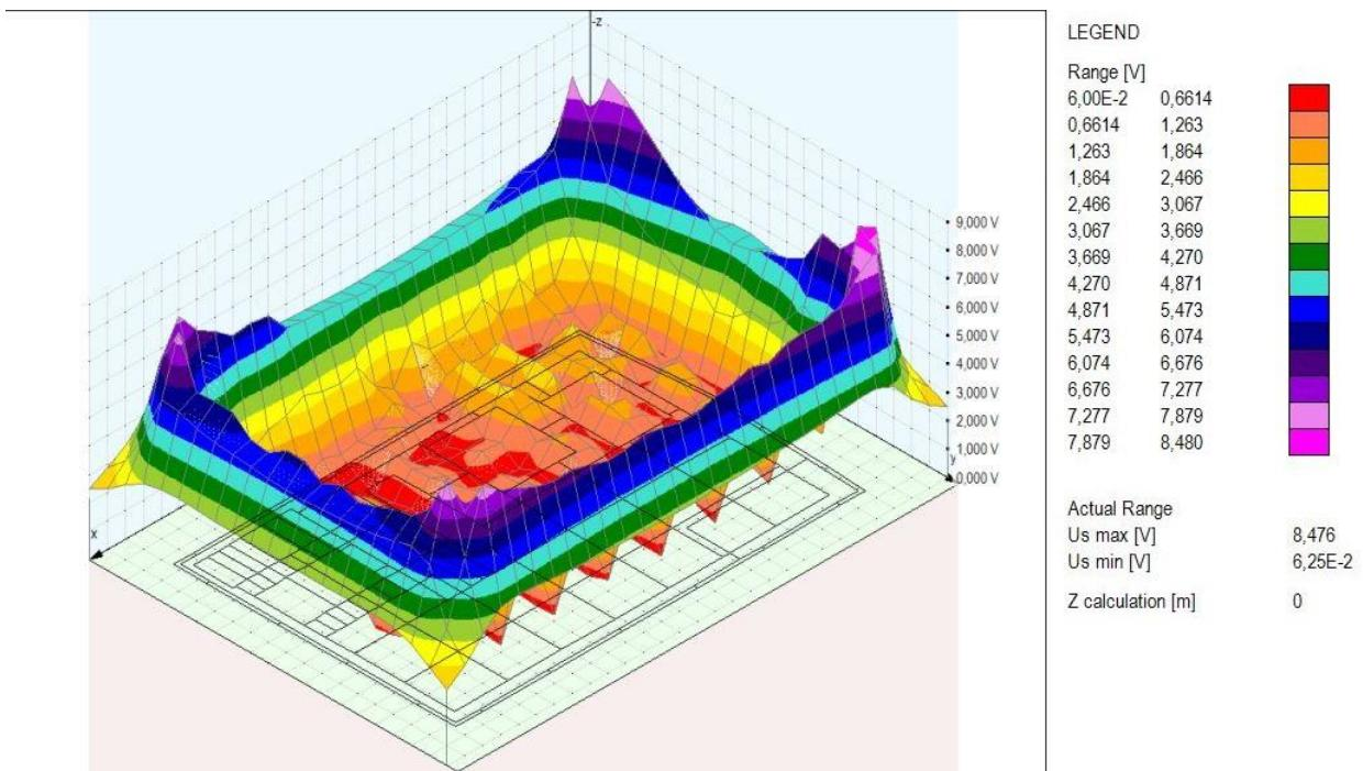
Slika 6.25. 3D prikaz napona koraka, ograda galvanski spojena
