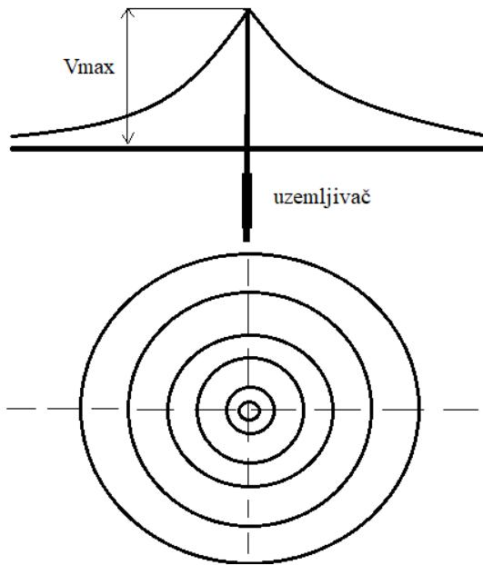
Slika 4.2. Potencijal zemlje i ekvipotencijalne linije oko štapnog uzemljivača
