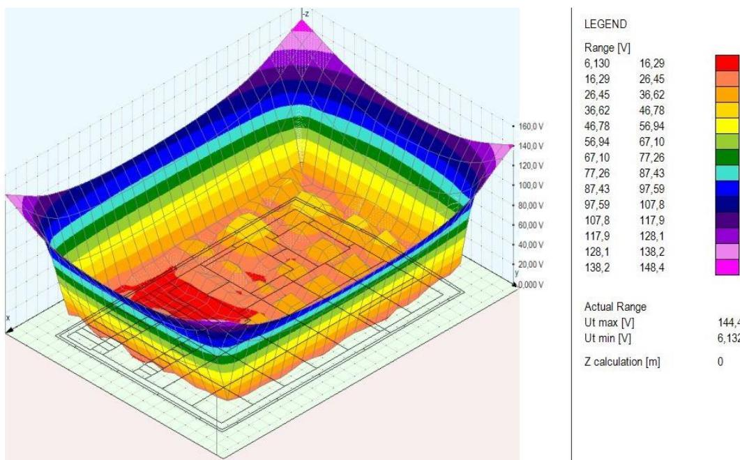
Slika 6.23. 3D prikaz napona dodira, ograda galvanski spojena
