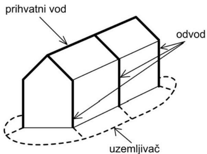
Slika 3.5. Gromobransko uzemljenje [1]
