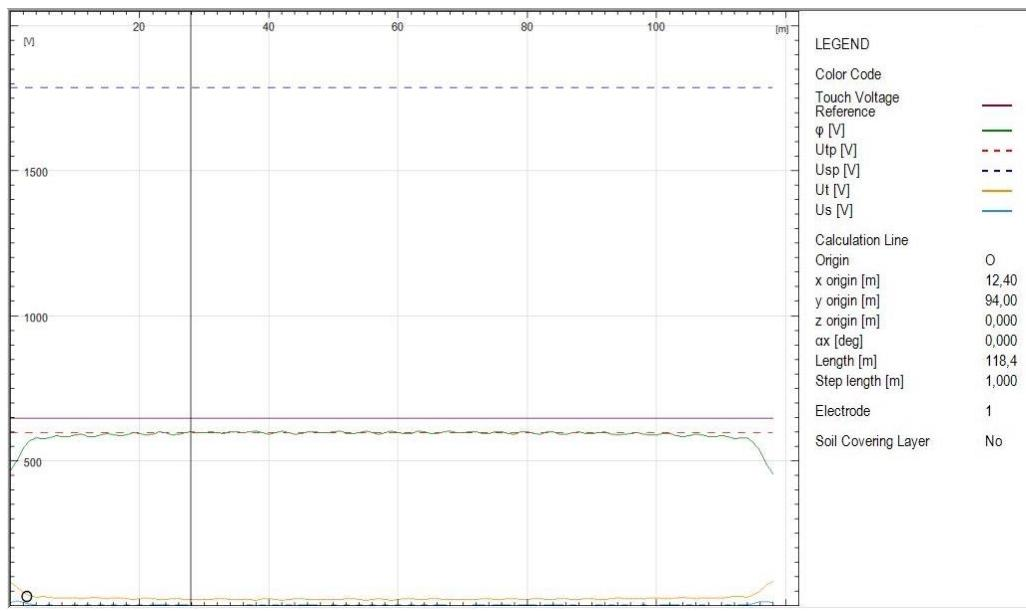
Slika 6.27. Graf naponi dodira i koraka uz istočnu ogradi na udaljenosti 1m, ograda galvanski spojena
