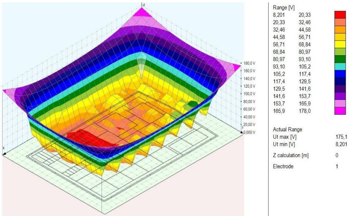
Slika 6.11. 3D prikaz napona dodira, ograda galvanski odvojena
