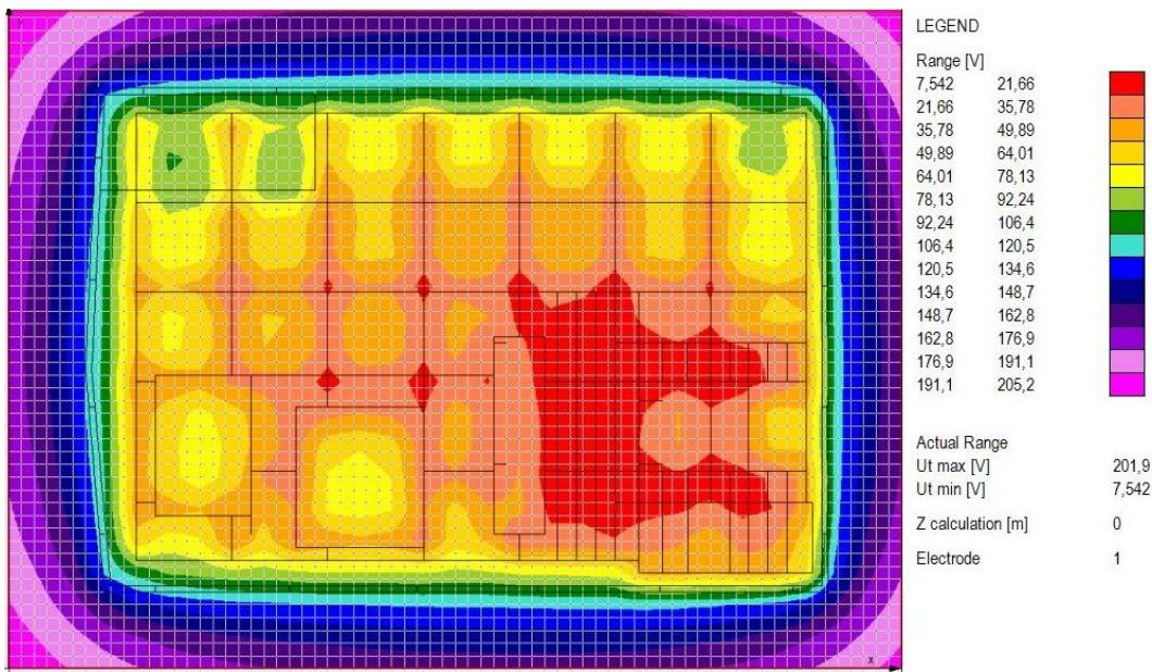
Slika 6.33. 2D prikaz napona dodira, ograda galvanski odvojena
