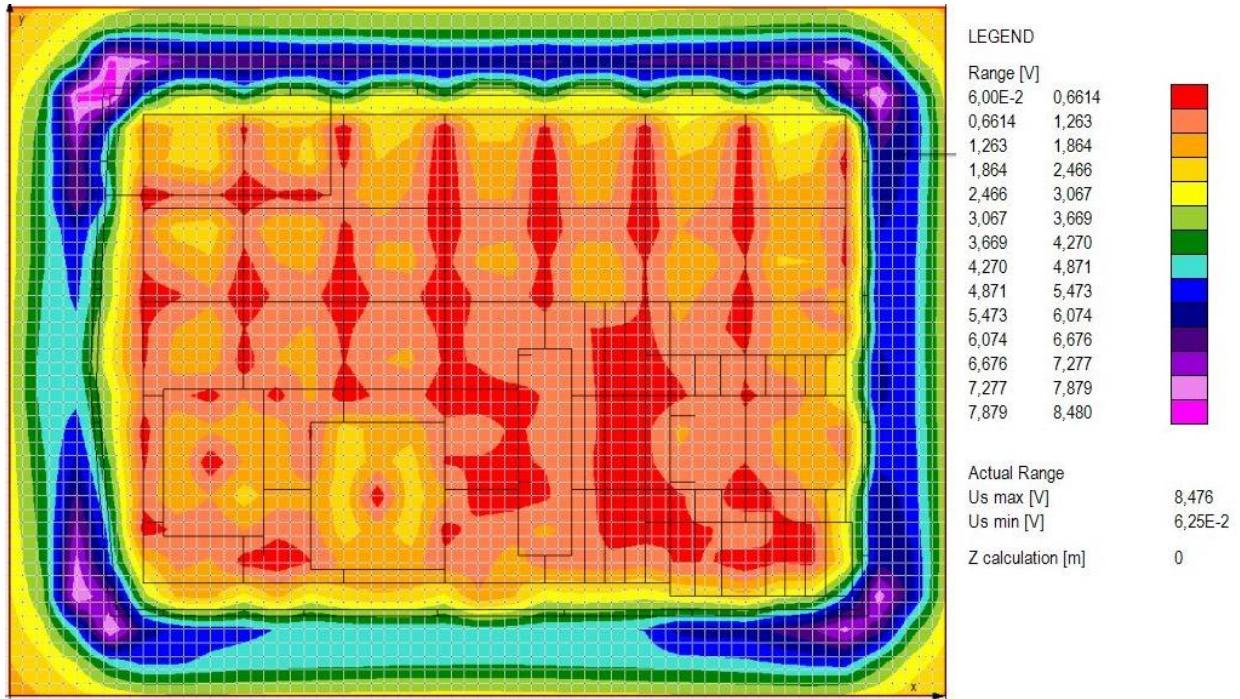
Slika 6.24. 2D prikaz napona koraka, ograda galvanski spojena
