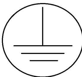
Slika 3.1. Simbol za uzemljenje u elektrotehnici
