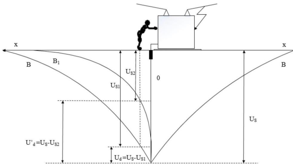
Slika 4.3. Dodirni napon i raspodjela potencijala oko uzemljivača [1]
