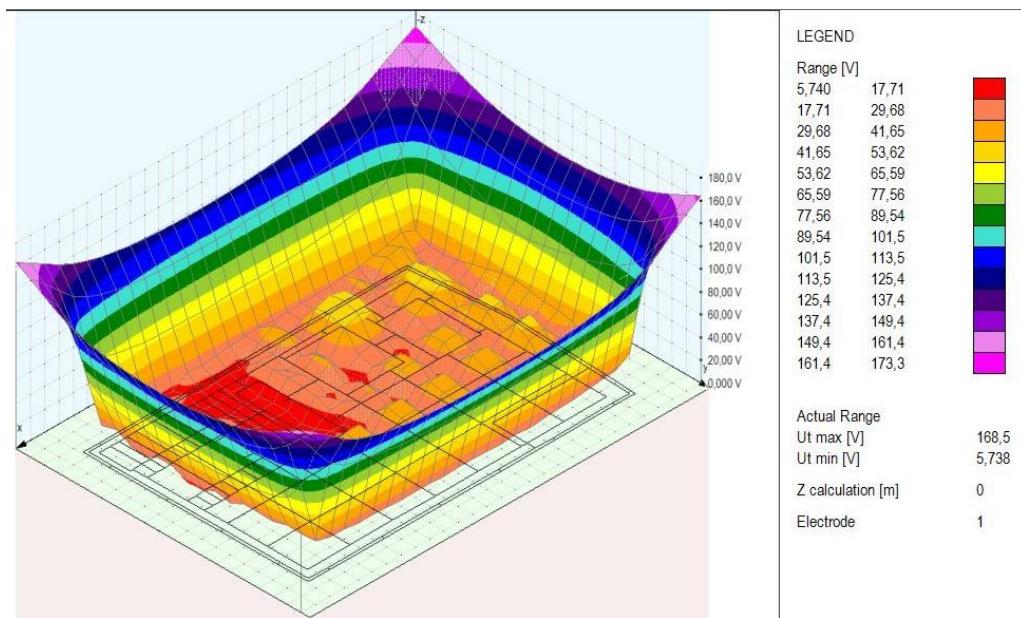
Slika 6.46. 3D prikaz napona dodira, ograda galvanski spojena
