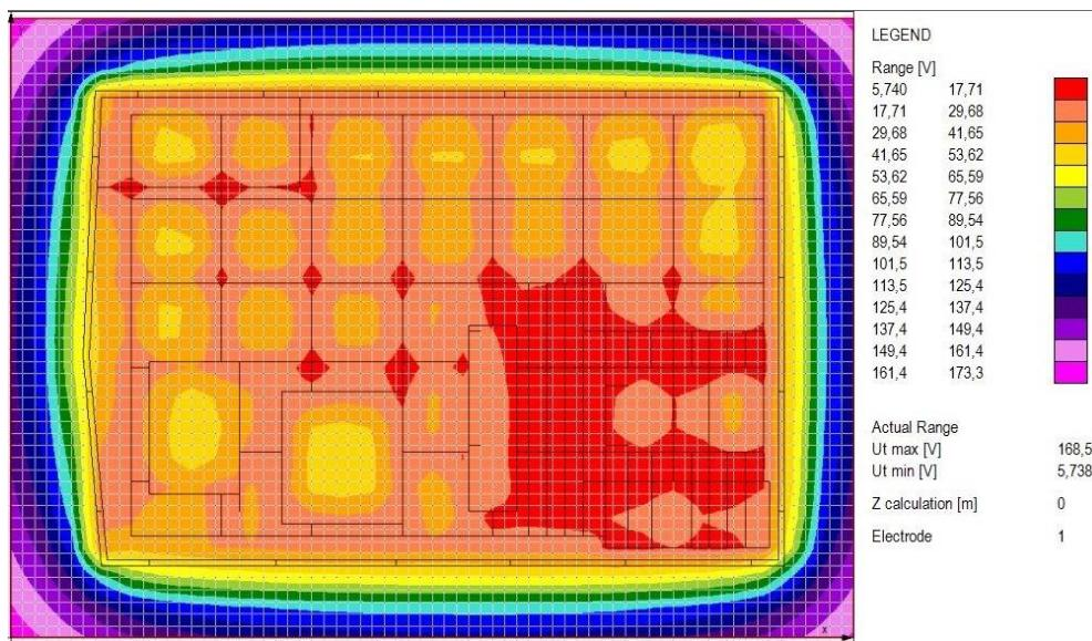
Slika 6.45. 2D prikaz napona dodira, ograda galvanski spojena
