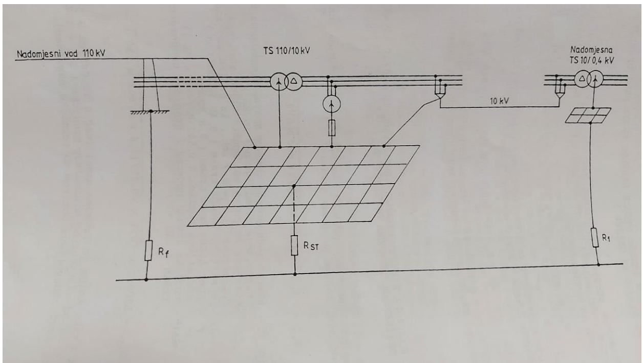
Slika 6.1. Prikaz sustava uzemljenja TS 110/10 kV [12]
