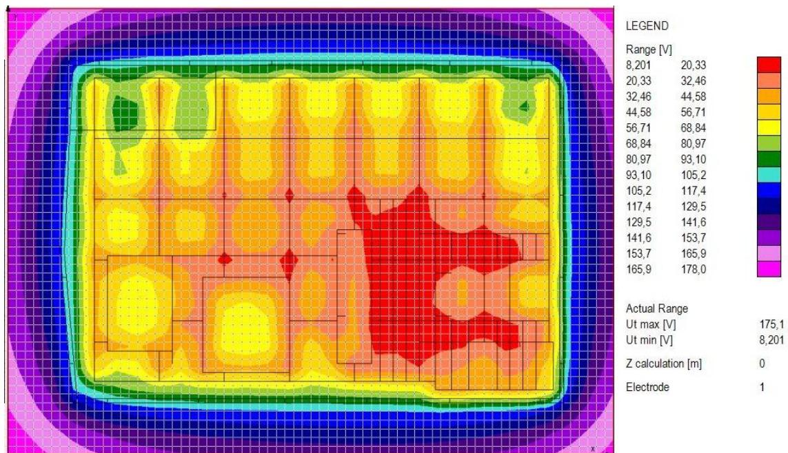
Slika 6.10. 2D prikaz napona dodira, ograda galvanski odvojena
