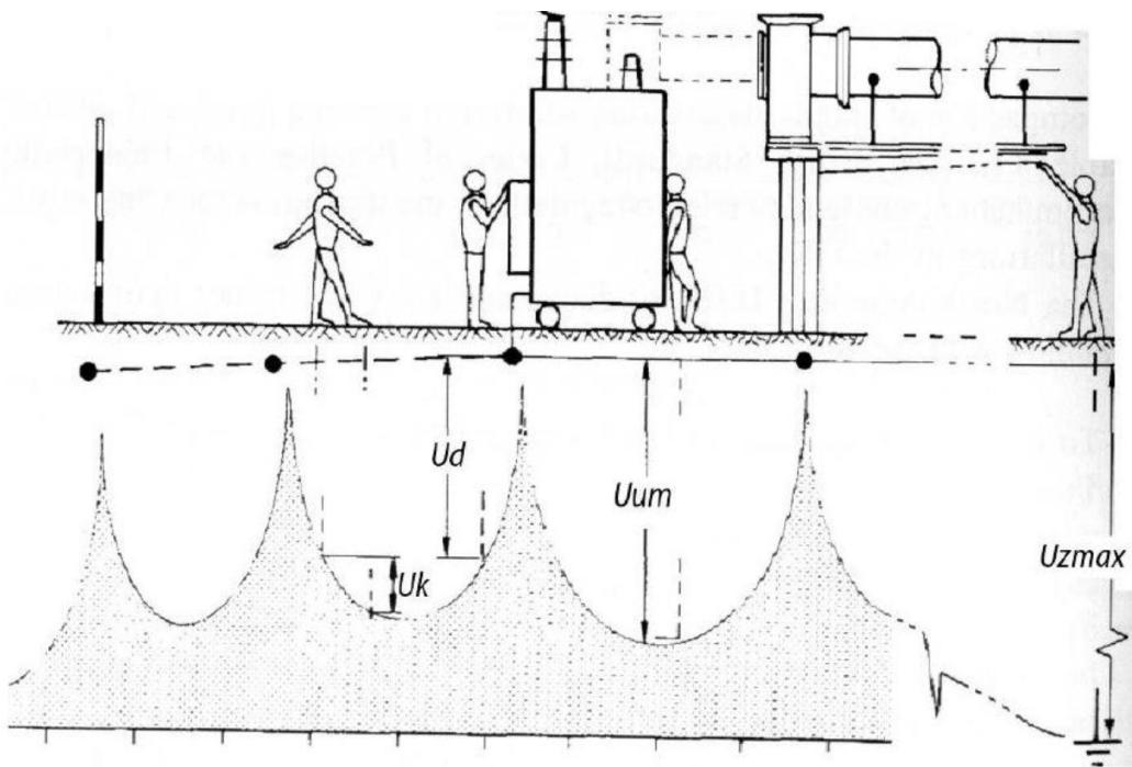
Slika 4.6. Iznošenje potencijala
