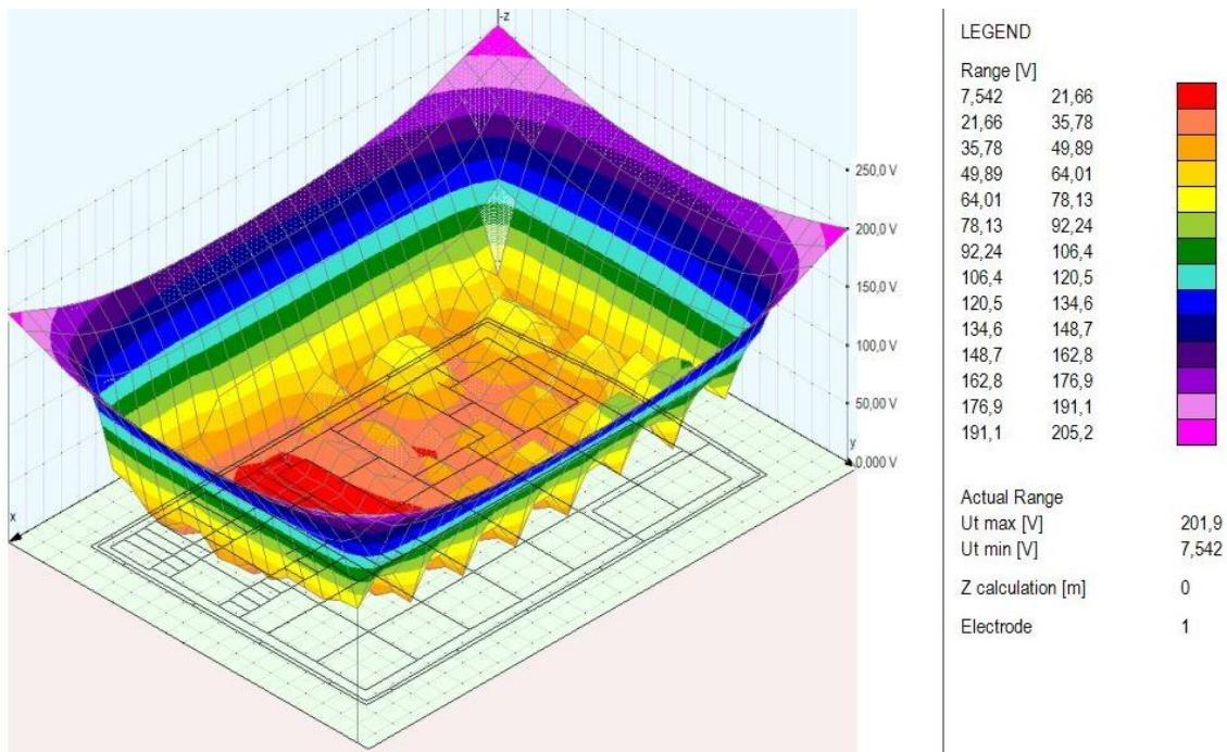
Slika 6.34. 3D prikaz napona dodira, ograda galvanski odvojena
