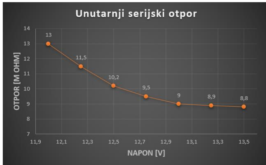
Slika 4.10. Krivulja koja predstavlja omjer unutarnjeg otpora akumulatorske baterije[ohm] i napona [V]
