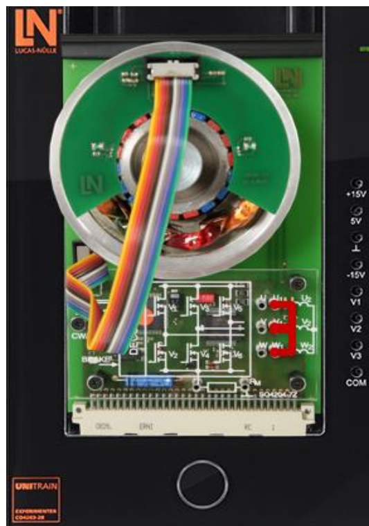
Slika 6.19. Shema za spajanje motora u zakočeno stanje
