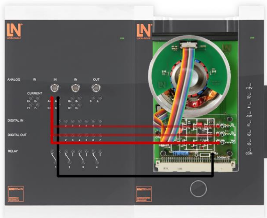
Slika 6.3. Shema spajanja za određivanja naponskih razina
