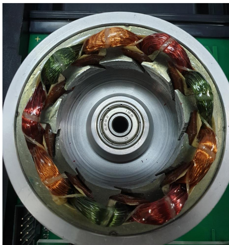
Slika 4.2. Namoti unutar statora
