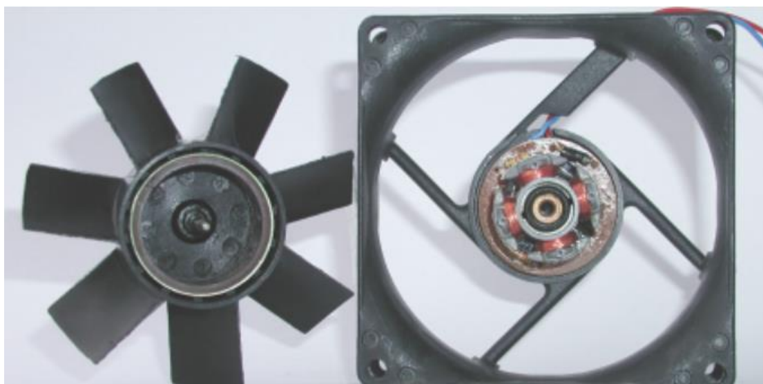
Slika 4.4. BLDC s vanjskim rotorom [6]
