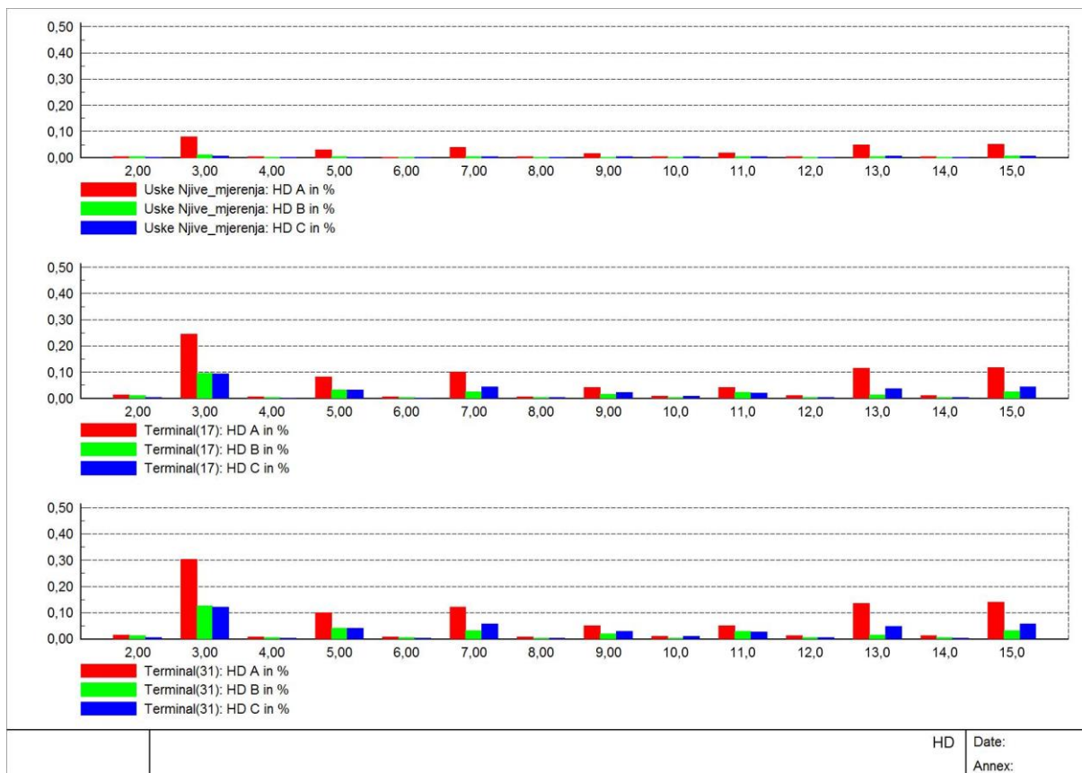
Slika 4.9. Prvih 15 harmonika u sve tri faze uz kompenzaciju i aktivan filter na početku izvoda
