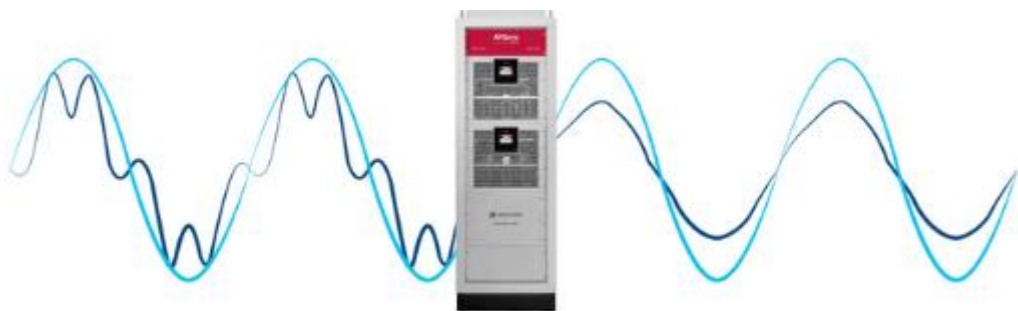
Slika 3.3. Ispravljanje nesinusnih valnih oblika pomoću aktivnih filtera [25]
