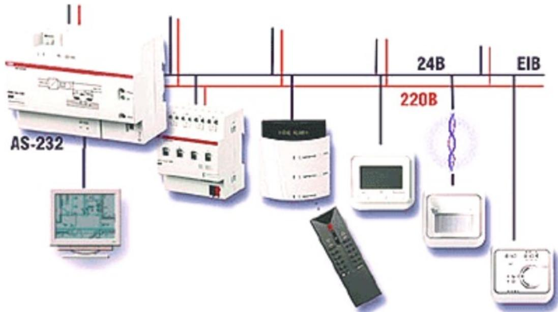
Sl.4.2 Elementi naprednog sustava upravljanja rasvjetom, [10]
