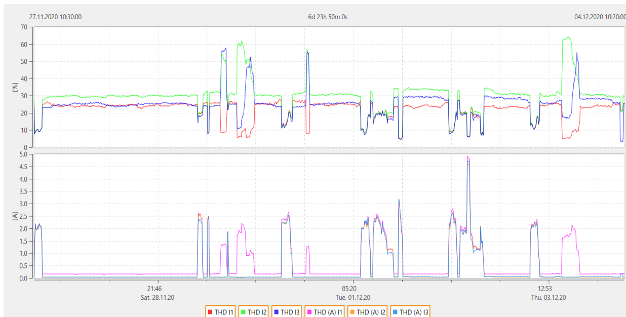
Sl. 5.28. Usporedba strujnog THD-a – relativni i apsolutni iznosi
