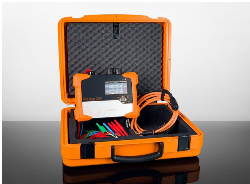
Sl. 5.2. Uređaj za mjerenje PQ-Box 200 proizvođača A. Eberle [22]
