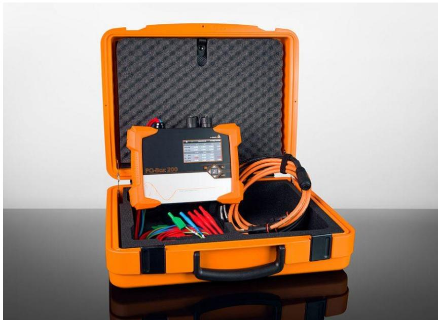
Sl. 5.2. Uređaj za mjerjenje PQ-Box 200 proizvođača A. Eberle [22]
